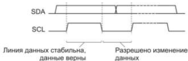
Рисунок 11.1 – Передача бита данных
