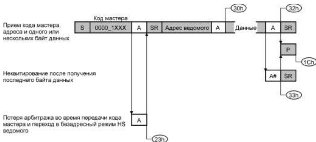
Рисунок 11.21 – Режим HS ведомого приемника
