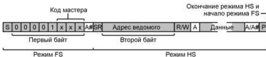
Рисунок 11.15 – Переход в режим HS и обратно в режим FS
