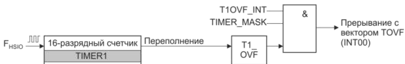
Рисунок 12.1 – Функциональная схема блока таймера 1
