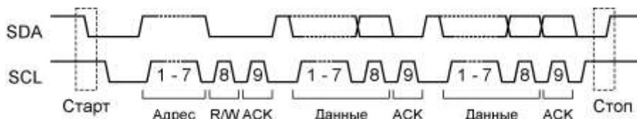
Рисунок 16.8 – Передача данных с 7-битной адресацией
