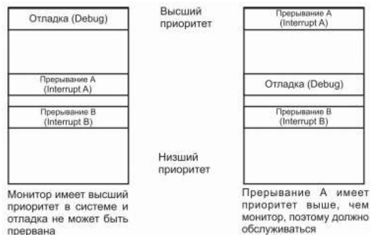
Рисунок 24.4 – Простая и расширенная модели отладки
