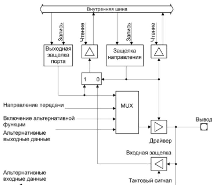
Рисунок 11.2 – Структурная схема вывода порта P0
