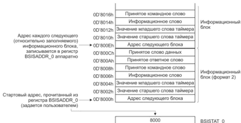
Рисунок 20.5 – Пример заполнения ОЗУ в режиме монитора шины
