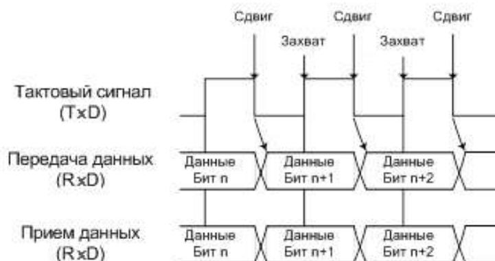
Рисунок 14.5 – Временная диаграмма работы в синхронном режиме
