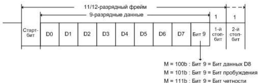
Рисунок 14.3 – Асинхронный 9-разрядный фрейм (младшим битом вперед)
