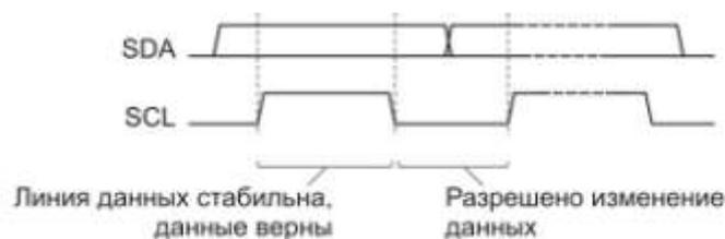
Рисунок 16.1 – Передача бита данных
