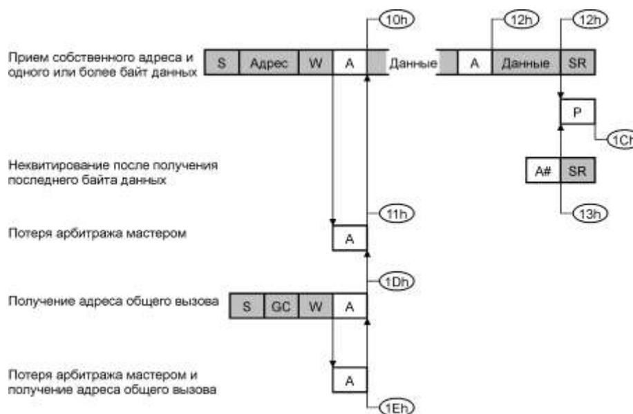
Рисунок 16.20 – Режим FS ведомого приемника
