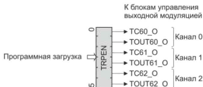
Рисунок 19.33 – Соответствие битов поля TRPEN и линий каналов
