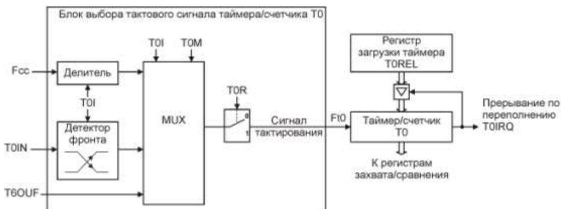
Рисунок 18.3 – Таймер/счетчик T0 и его схема тактирования
