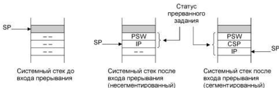
Рисунок 7.2 – Сохранение состояния текущей задачи в системном стеке
