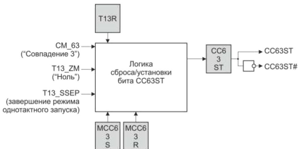
Рисунок 19.22 – Функциональная схема управления битом CC63ST
