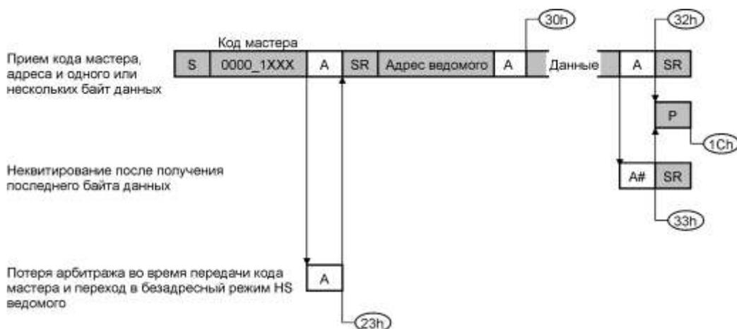
Рисунок 16.21 – Режим HS ведомого приемника
