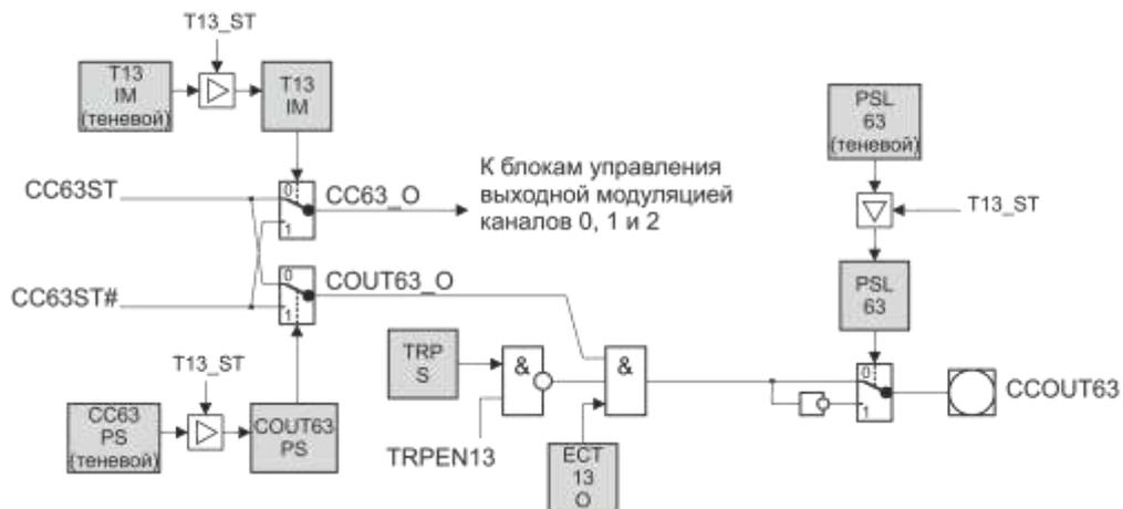
Рисунок 19.23 – Блок управления выходной модуляцией канала 3
