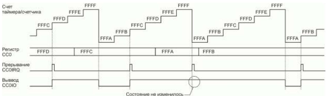
Рисунок 18.9 – Режим сравнения 3, значение регистра загрузки – FFFAh
