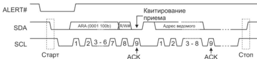
Рисунок 16.9 – Передача адреса отклика на сигнал предупреждения
