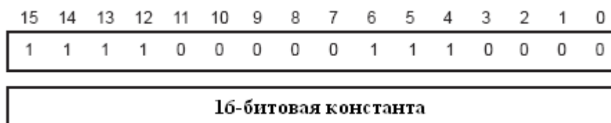
Рисунок 18 – Двухсловная команда RPT с адресацией, использующей 16-разрядное длинное непосредственное значение
