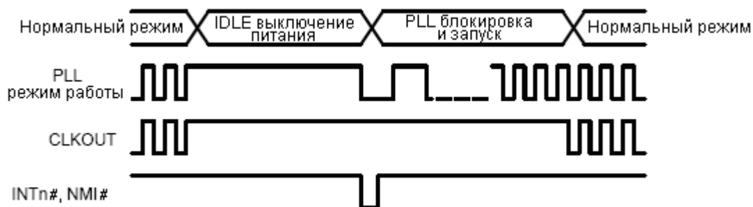
Рисунок 104 – Порядок запуска в режиме IDLE3
