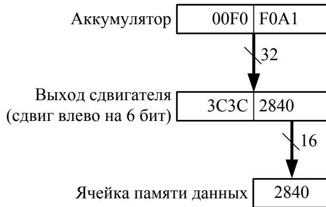
Рисунок 237 – Сдвиг и сохранение младшего слова аккумулятора
