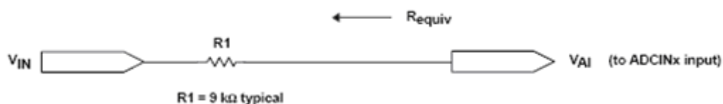
Рисунок 48 - Типичная схема вывода входа АЦП
