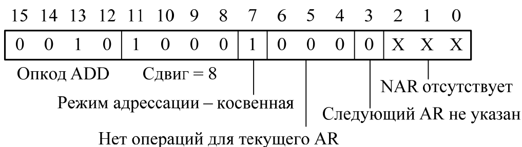
Рисунок 274 – Косвенная адресация без инкрементирования или декрементирования
