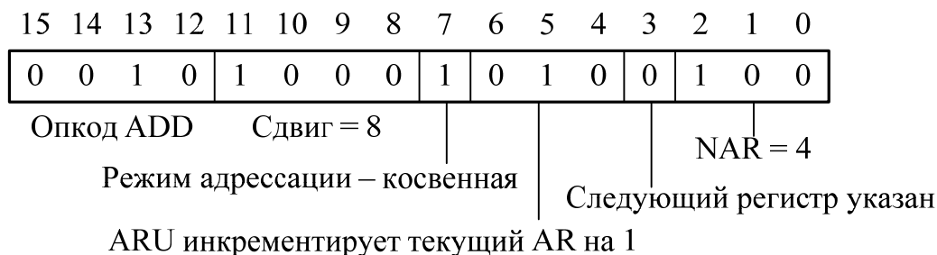
Рисунок 275 – Косвенная адресация с инкрементом на 1
