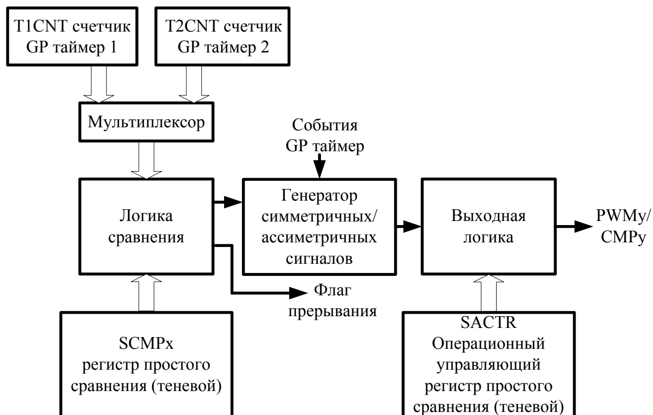
Рисунок 61 – Структурная схема блоков простого сравнения (x = 1, 2, 3; y = 7, 8, 9)
