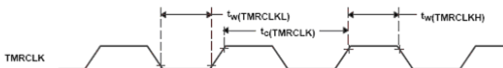
Рисунок 36 - Временная диаграмма входа внешнего тактирующего сигнала GP таймеров
