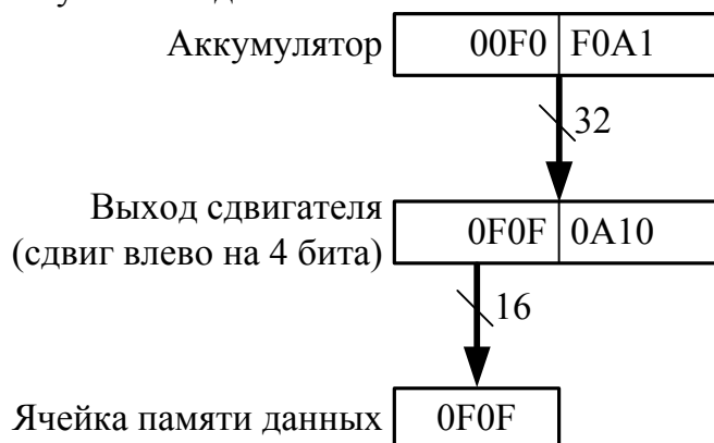
Рисунок 236 – Сдвиг и сохранение старшего слова аккумулятора
