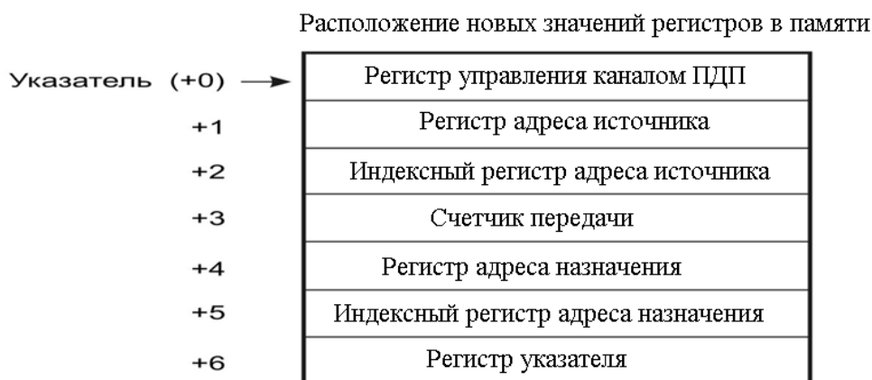
Рисунок 11.17 – Размещение новых значений регистров канала ПДП в памяти (SPLIT MODE=0)
