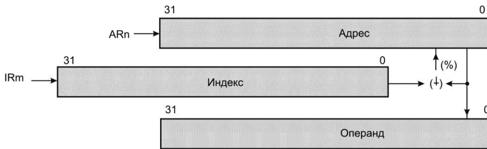
Пример 6.19 – Косвенная адресация с последующим добавлением и бит-реверсивной модификацией
