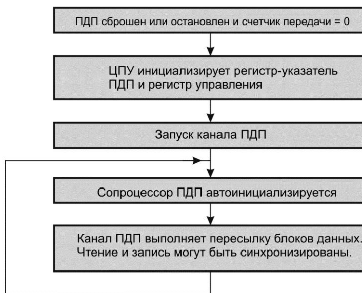
Рисунок 11.13 – Работа канала ПДП в режиме TRANSFER MODE = 10 2 (метод автоинициализации № 1а)
