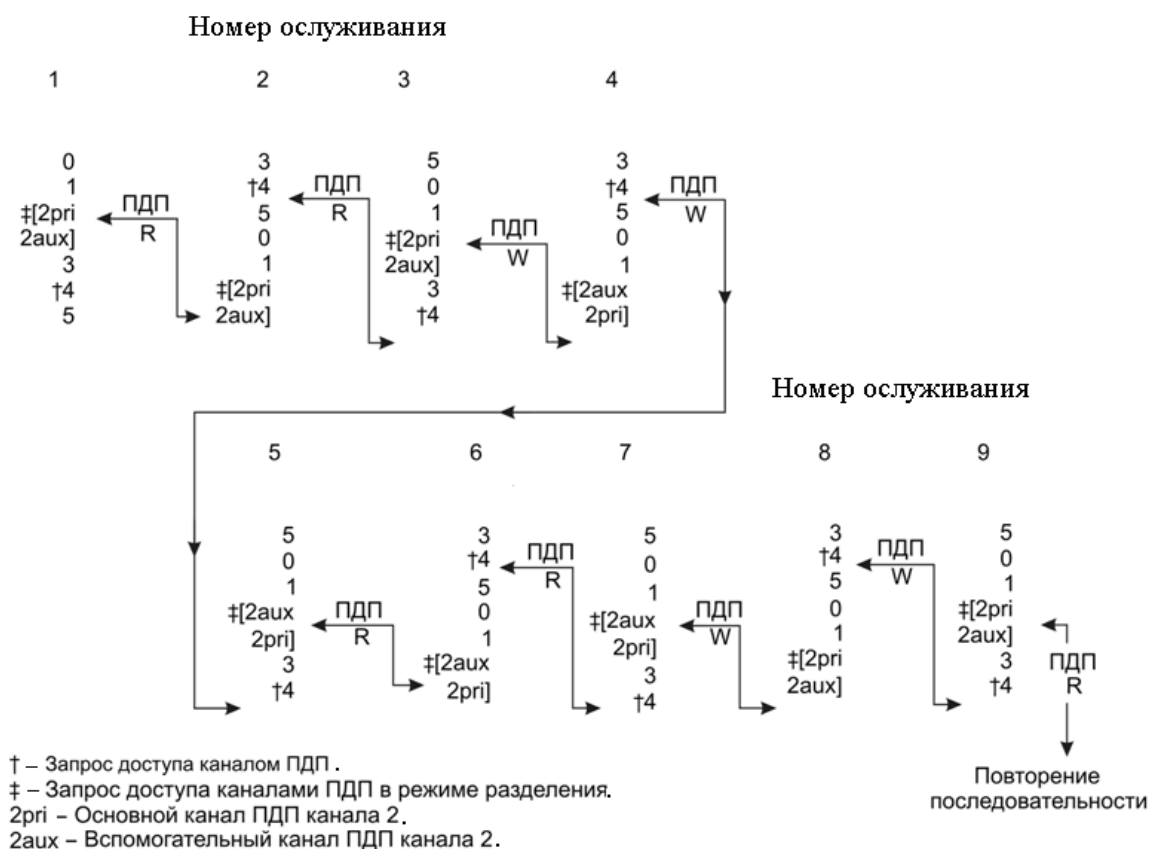
Рисунок 11.12 – Пример последовательности смены приоритетов при обслуживании в режиме с разделением
