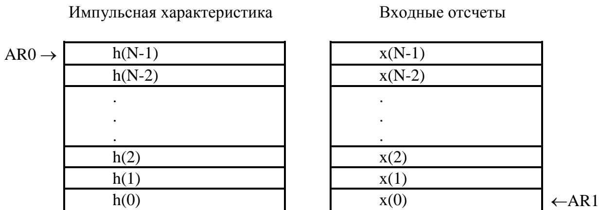
Рисунок 6.12 – Структура данных для КИХ-фильтров
