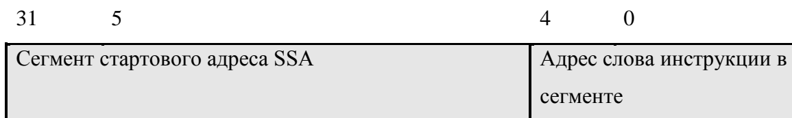
Рисунок 4.6 – Адресное разделение для управляющего алгоритма КЭШ
