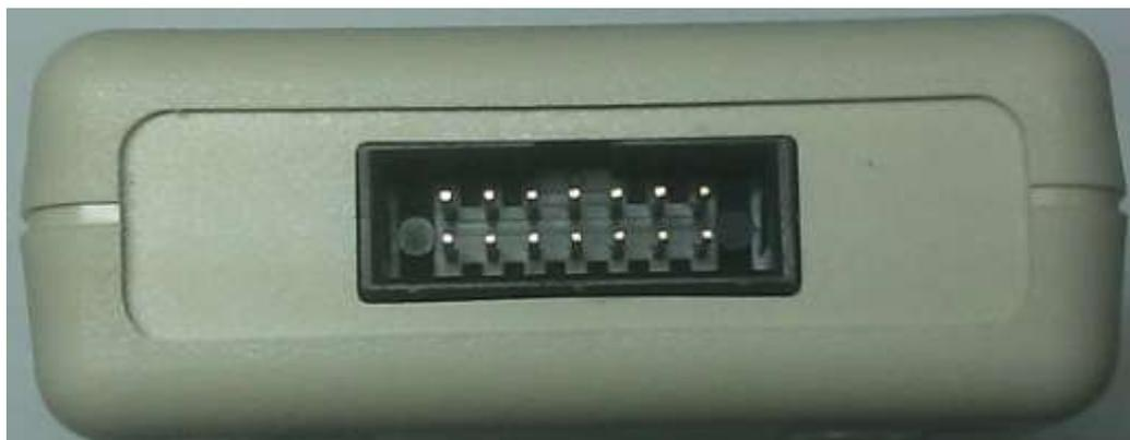
Рисунок 3 – Разъем IDC-14F эмулятора JEM-96
