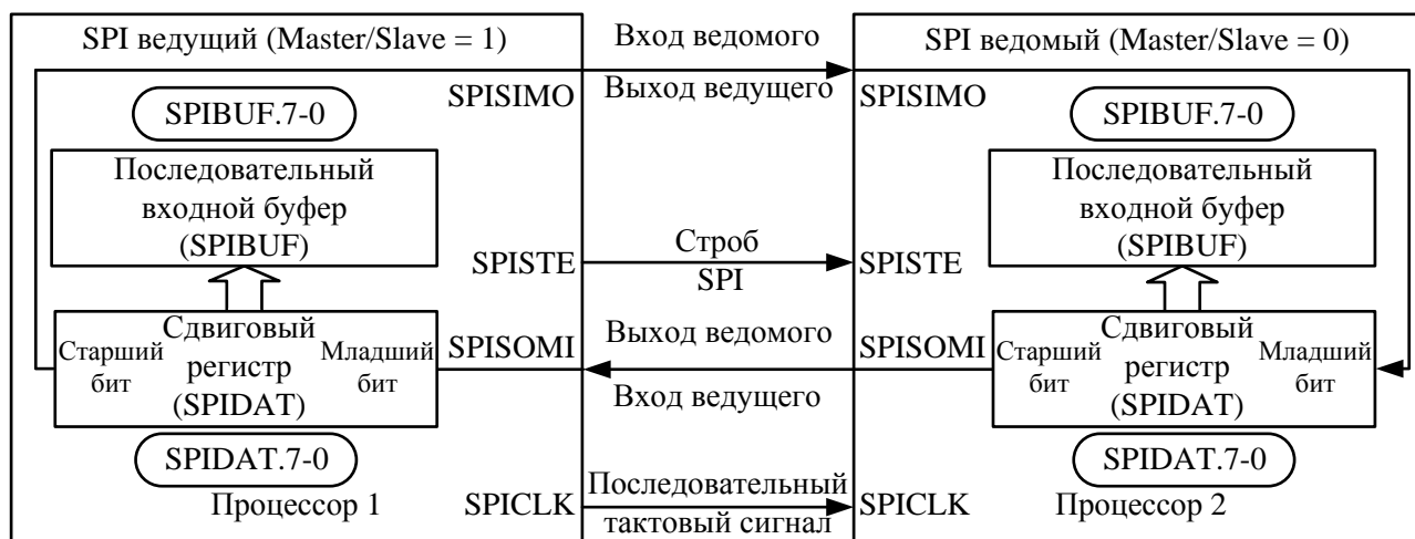
Рисунок 118 – Соединение ведущий (Master)/ведомый (Slave) модулей SPI (условие четырех контактов)
