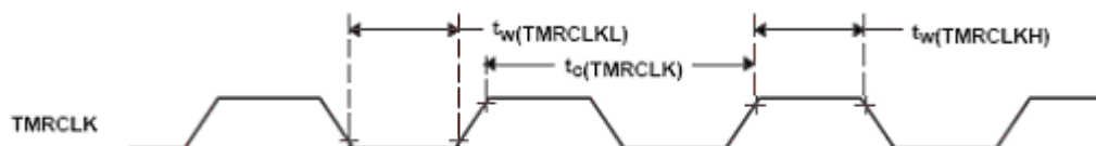
Рисунок 38 – Временная диаграмма входа внешнего тактирующего сигнала GP таймеров
