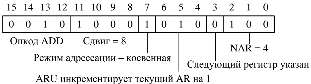
Рисунок 272 – Косвенная адресация с инкрементом на 1
