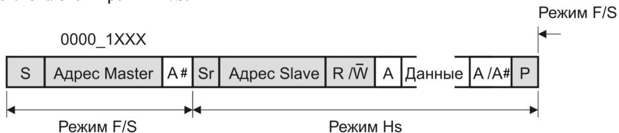
Рисунок 374 – Высокоскоростной режим (Hs)
