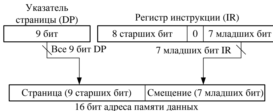
Рисунок 266 – Формирование адреса данных в режиме прямой адресации
