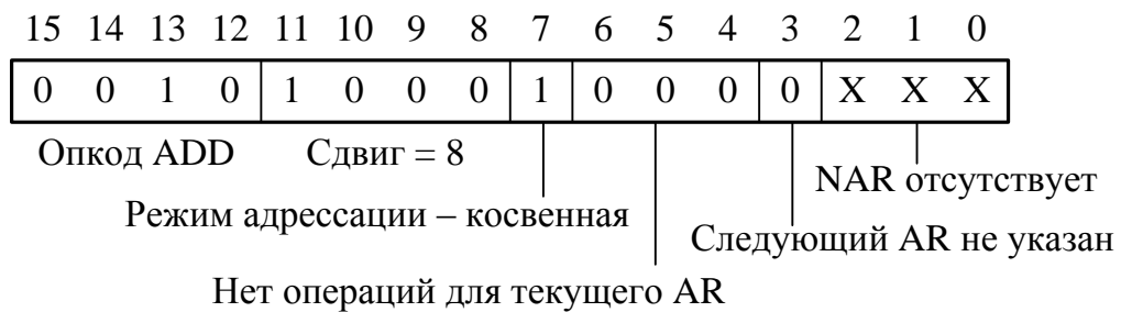
Рисунок 271 – Косвенная адресация без инкрементирования или декрементирования
