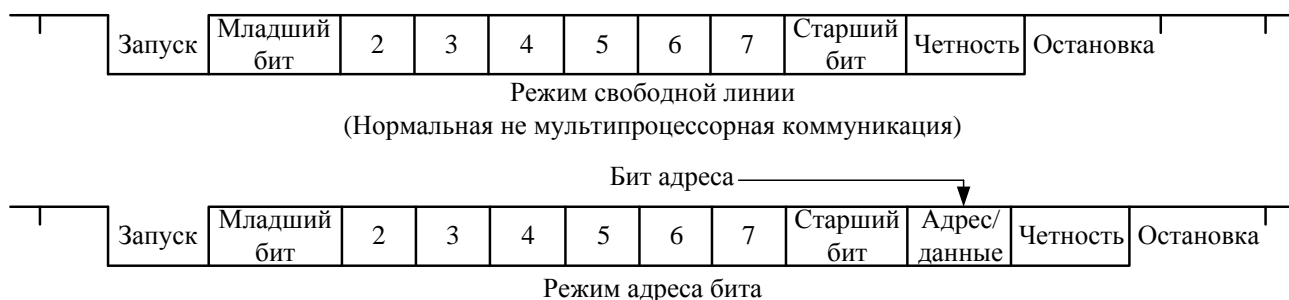
Рисунок 97 – Типичные форматы фреймов данных модуля SCI
