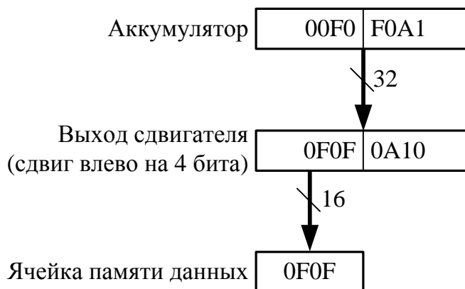
Рисунок 235 – Сдвиг и сохранение старшего слова аккумулятора
