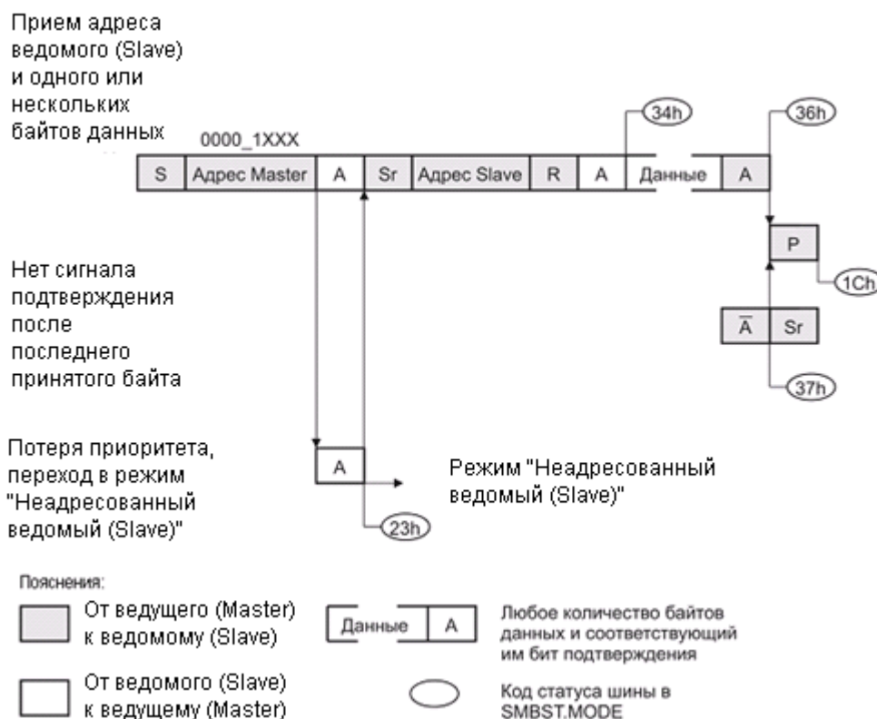
Рисунок 383 – Высокоскоростной режим (Hs) «Ведомый (Slave) передатчик»
