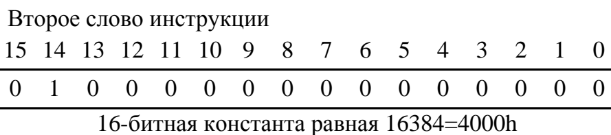
Рисунок 263 – Два слова загружаются последовательно в регистр инструкции в примере 2
