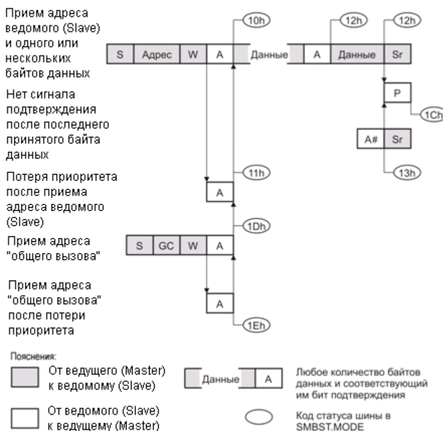
Рисунок 380 – Режим F/S «Ведомый (Slave) приемник», действия и статус
