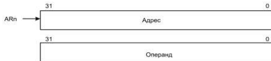
Рисунок 5.2 – Косвенная адресация через вспомогательный регистр
