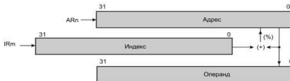
Рисунок 5.17 – Косвенная адресация с последующим сложением с индексом и циклической модификацией
