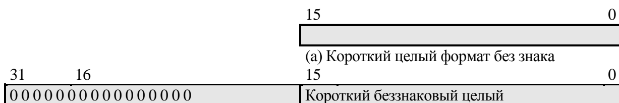
Рисунок 4.3 – Короткий целочисленный формат без знака (a) и с заполнением нулями (b)
