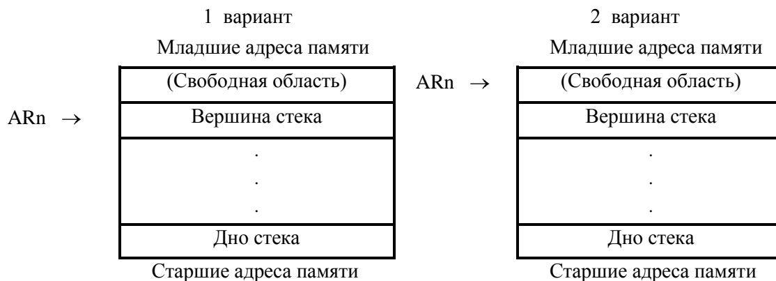
Рисунок 5.30 – Два варианта реализации стека
