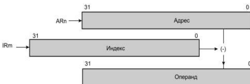
Рисунок 5.12 – Косвенная адресация с предварительным вычитанием индекса
