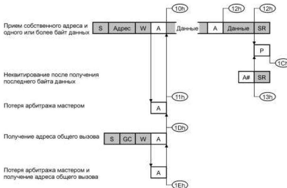
Рисунок 13.20 – Режим FS ведомого приемника
