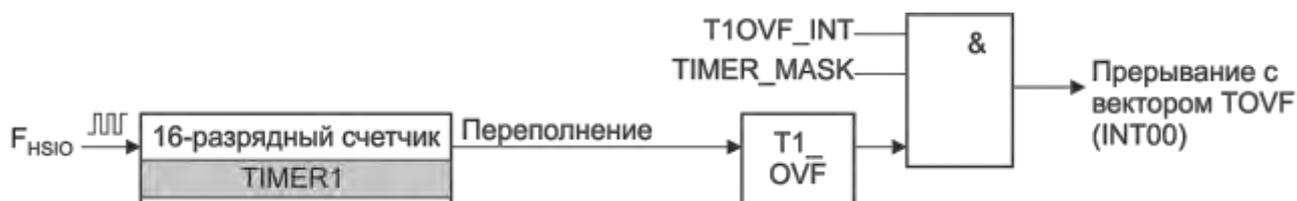
Рисунок 18.1 – Функциональная схема блока таймера 1
