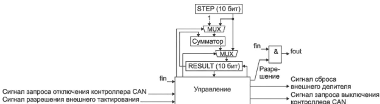
Рисунок 16.9 – Схема дробного делителя
