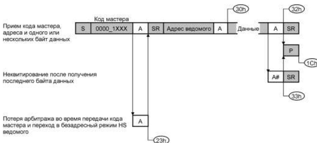
Рисунок 13.21 – Режим HS ведомого приемника
