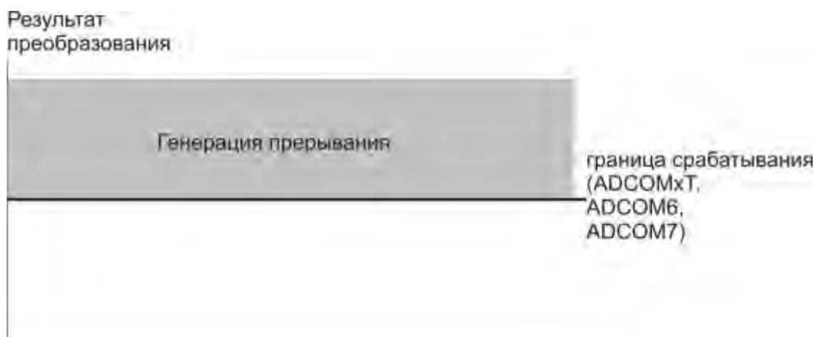
Рисунок 19.10 – Срабатывание компараторов по верхней границе
