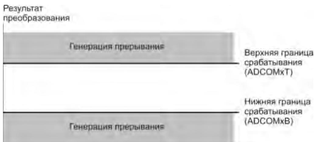
Рисунок 19.12 – Срабатывание компараторов по выходу из диапазона
