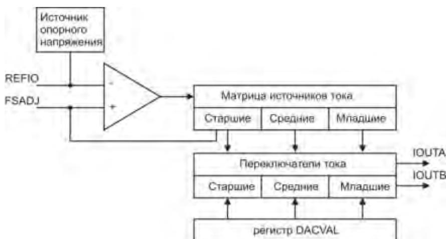
Рисунок 20.1 – Структурная схема блока ЦАП
