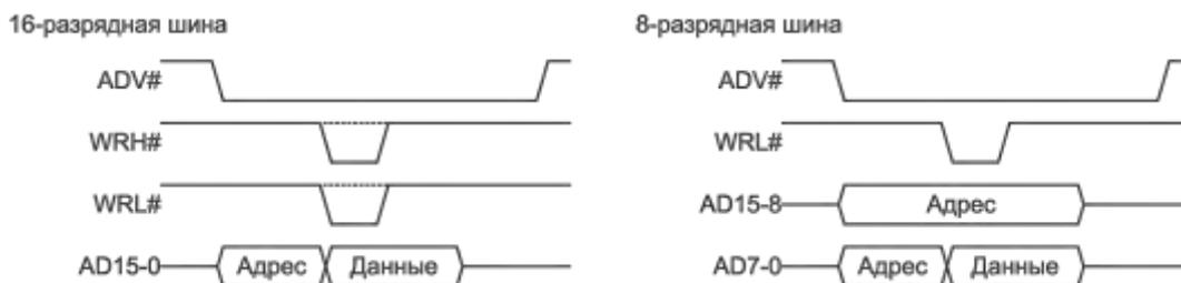
Рисунок 23.15 – Временные соотношения для режима строба достоверного адреса и записи
