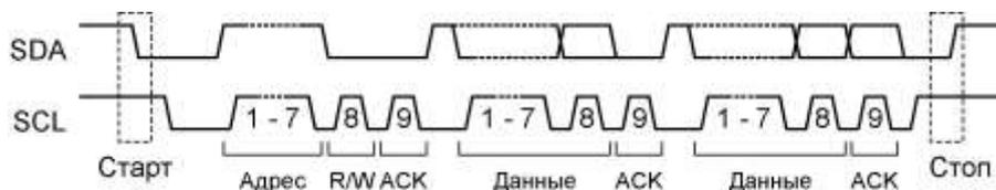
Рисунок 13.8 – Передача данных с 7-битной адресацией
