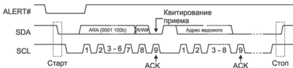
Рисунок 13.9 – Передача адреса отклика на сигнал предупреждения
