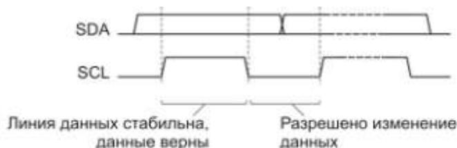
Рисунок 13.1 – Передача бита данных
