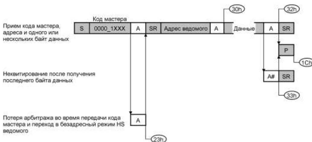
Рисунок 16.21 – Режим HS ведомого приемника
