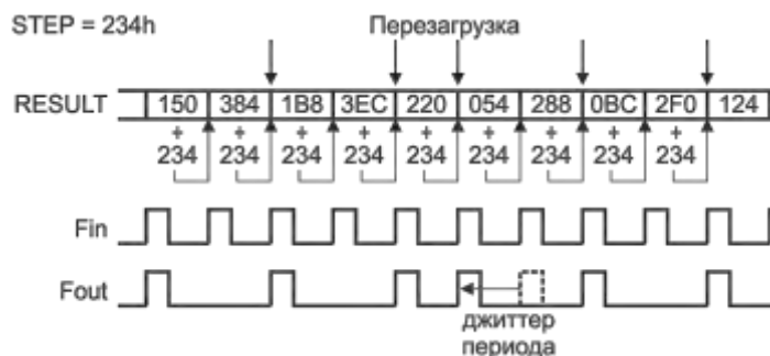
Рисунок 17.11 – Формирование сигнала с частотой f_{out} в режиме дробного деления
