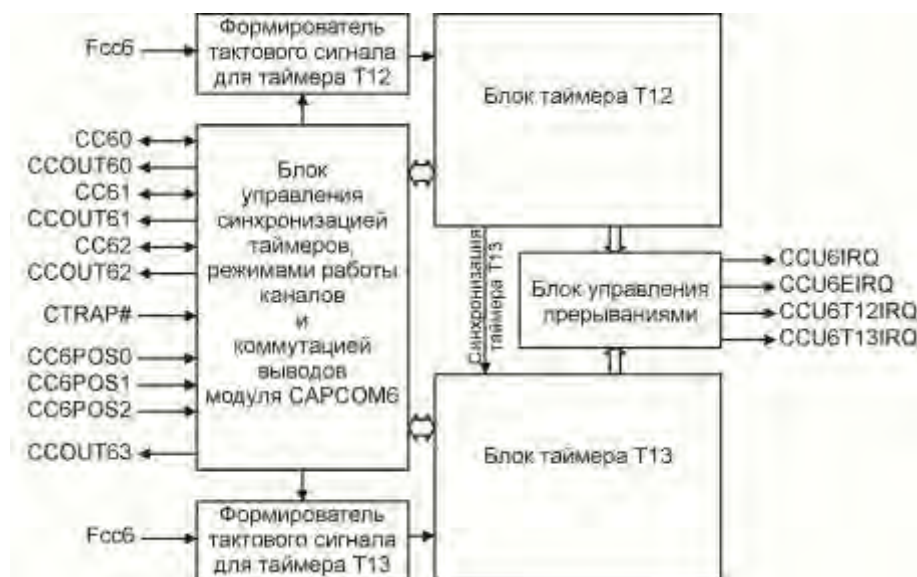
Рисунок 19.2 – Структурная схема модуля CAPCOM6
