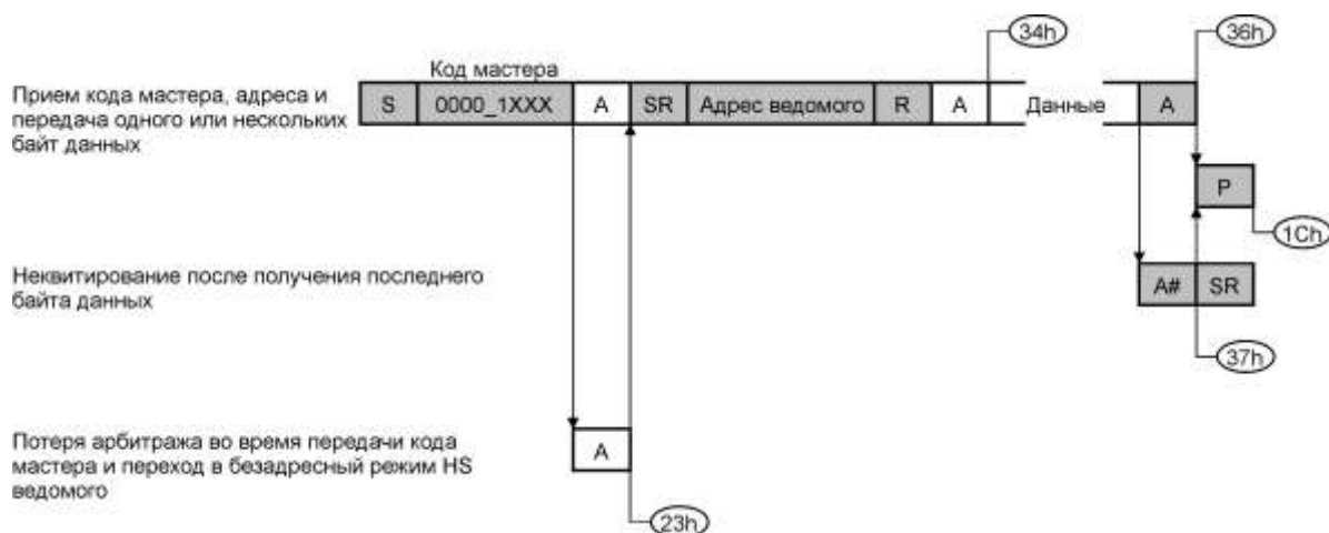
Рисунок 16.23 – Режим HS ведомого передатчика
