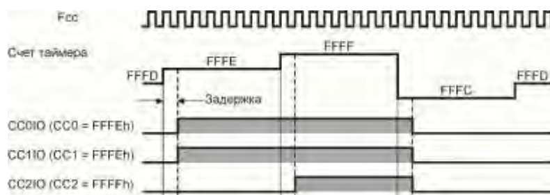
Рисунок 18.17 – Нормальный режим. Частота работы таймера/счетчика f_{cc}/8
