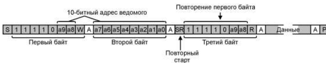
Рисунок 16.11 – Получение данных от ведомого с 10-битным адресом
