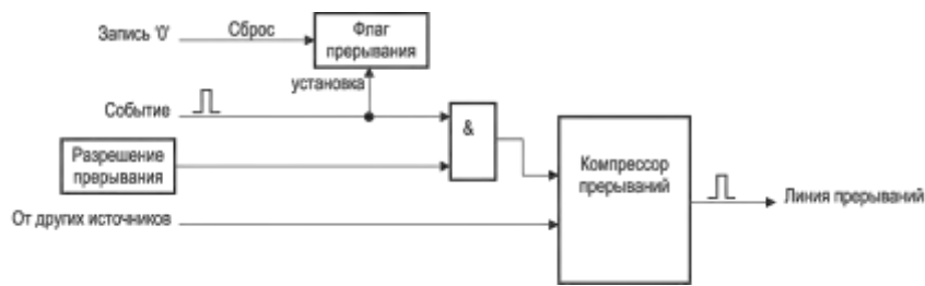
Рисунок 17.12 – Структура формирования запроса на прерывание
