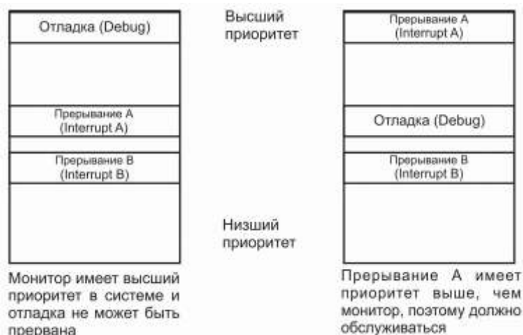
Рисунок 24.4 – Простая и расширенная модели отладки
