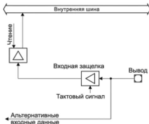
Рисунок 11.7 – Структурная схема вывода порта P5
