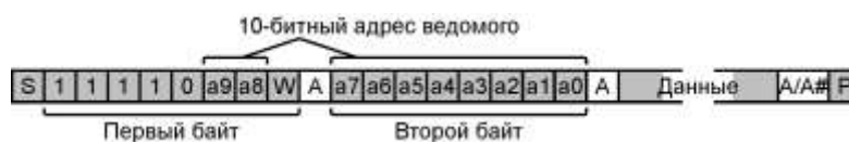
Рисунок 16.10 – Передача данных ведомому с 10-битным адресом (для расшифровки обозначений, применяемых на рисунке, следует обратиться к таблице 16.1)
