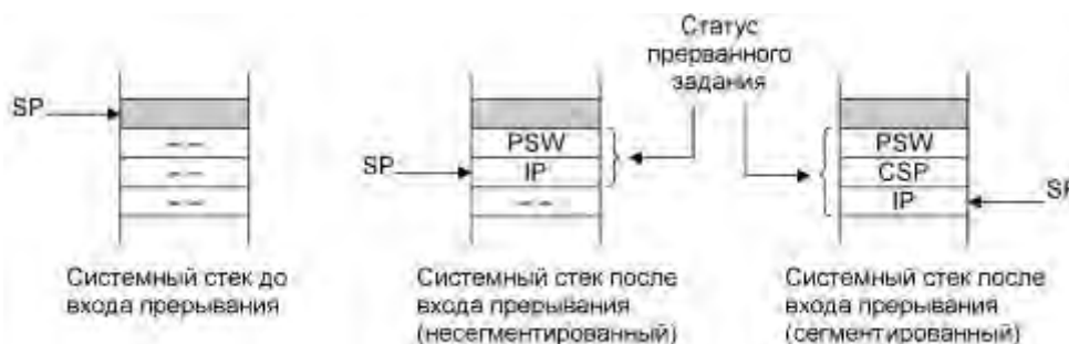
Рисунок 7.2 – Сохранение состояния текущей задачи в системном стеке
