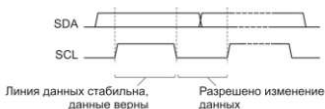
Рисунок 16.1 – Передача бита данных
