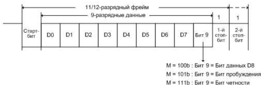
Рисунок 14.3 – Асинхронный 9-разрядный фрейм (младшим битом вперед)
