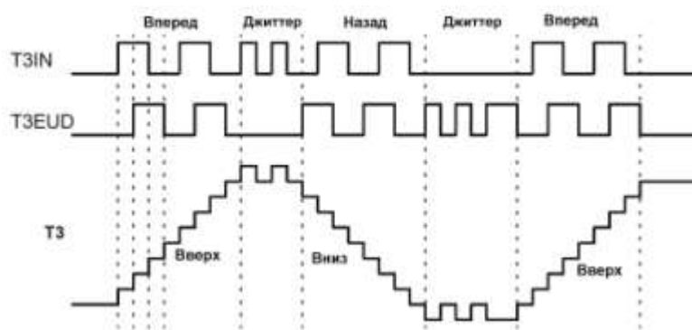
Рисунок 13.8 – Пример работы таймера T3 в режиме внешнего инкрементирования (T3I = 011b)
