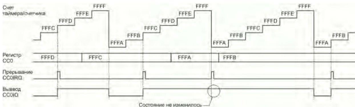
Рисунок 18.9 – Режим сравнения 3, значение регистра загрузки – FFFAh
