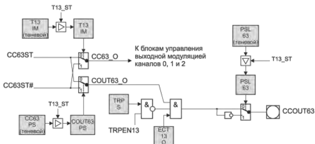
Рисунок 19.23 – Блок управления выходной модуляцией канала 3
