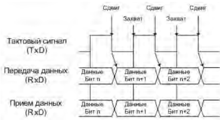
Рисунок 14.5 – Временная диаграмма работы в синхронном режиме
