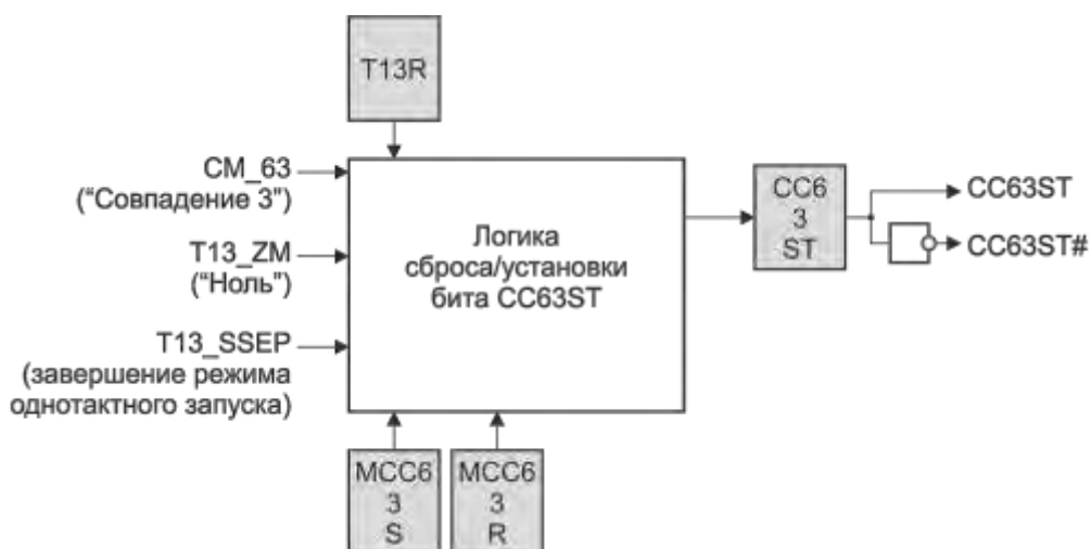
Рисунок 19.22 – Функциональная схема управления битом CC63ST
