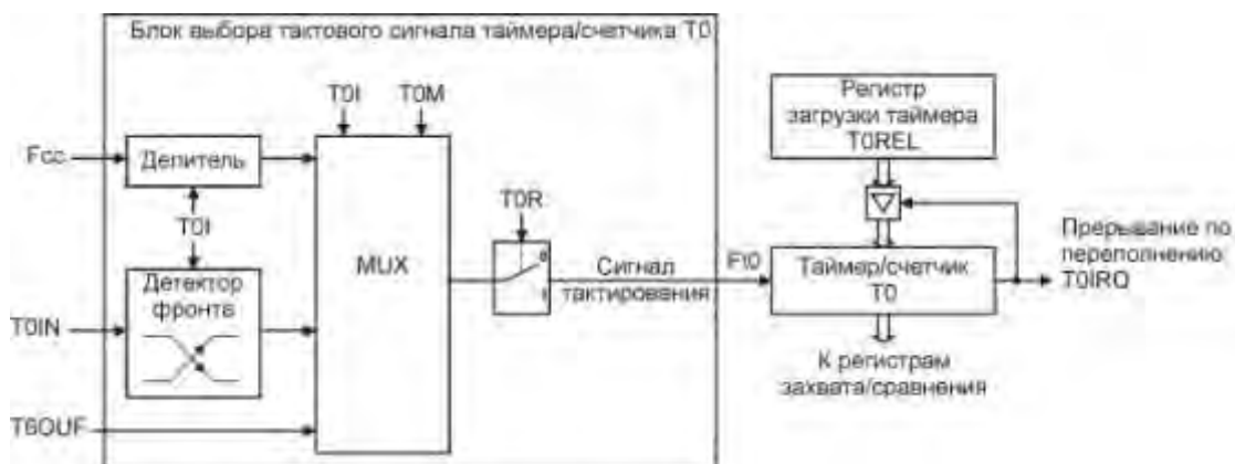
Рисунок 18.3 – Таймер/счетчик T0 и его схема тактирования
