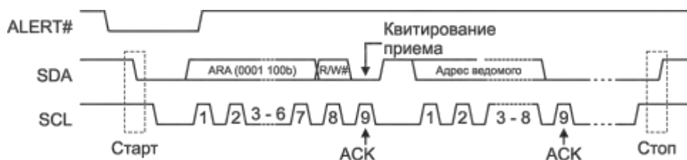
Рисунок 16.9 – Передача адреса отклика на сигнал предупреждения
