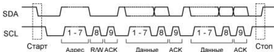
Рисунок 16.8 – Передача данных с 7-битной адресацией
