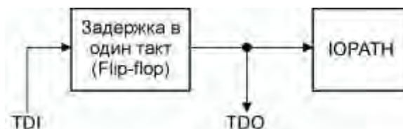
Рисунок 24.7 – Схема загрузки регистра IOPATH
