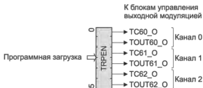
Рисунок 19.33 – Соответствие битов поля TRPEN и линий каналов
