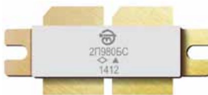
Рис. 2. Транзистор 2П9805С ( P_{вых} = 150 Вт, f = 860 МГц, U_{си} = 32 В)
