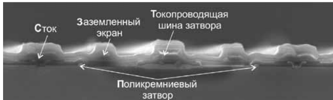
Рис. 4. Микрофотография поперечного сечения LDMOS транзисторного кристалла с двумя уровнями металлов и заземленным экраном
