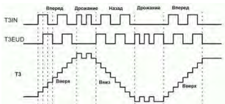
Рисунок 14.10 – Пример работы таймера T3 в режиме внешнего инкрементирования T3I = 011_B
