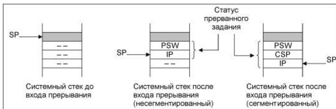
Рисунок 10.4 – Сохранение состояния в системном стеке
