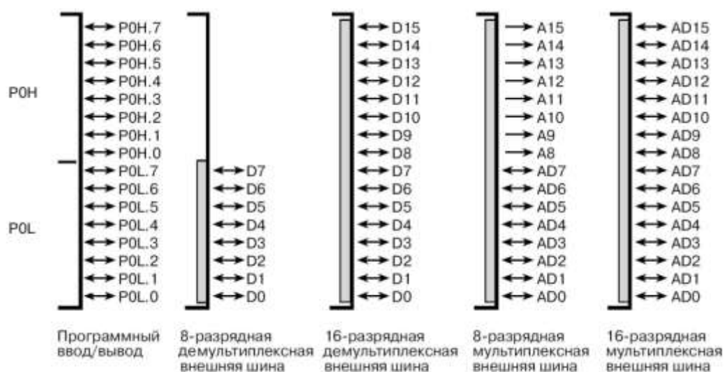
Рисунок 9.6 – Ввод и вывод порта P0 и его альтернативные функции
