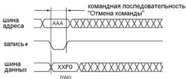
Рисунок 5.5 – Командная последовательность «Отмена команды»
