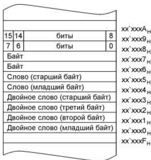
Рисунок 4.2 – Хранение слов, байтов и битов памяти, организованных по байтовому принципу
