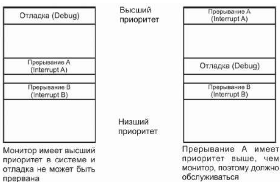
Рисунок 7.4 – Простая и расширенная модели отладки
