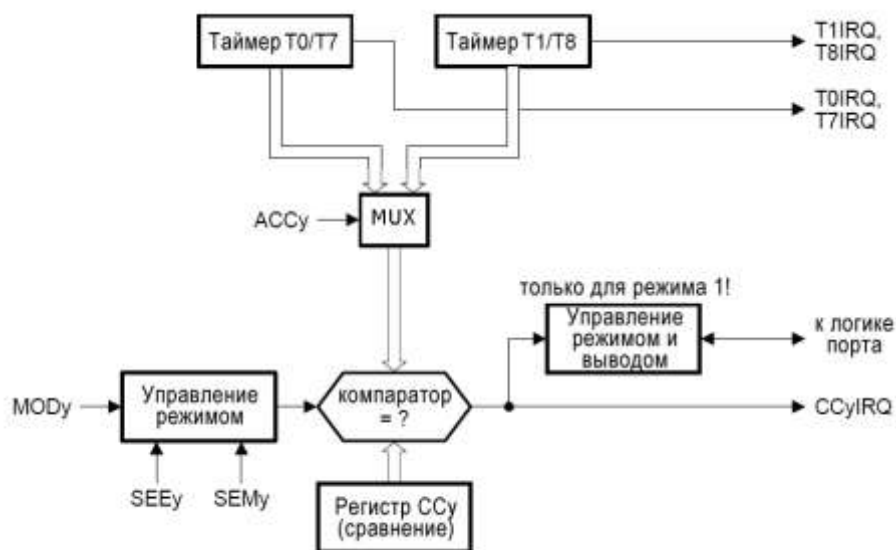
Рисунок 17.15 – Блок-диаграмма режимов сравнения 0 и 1
