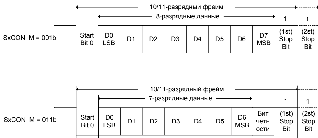
Рисунок 20.7 – Асинхронный 8-битный фрейм
