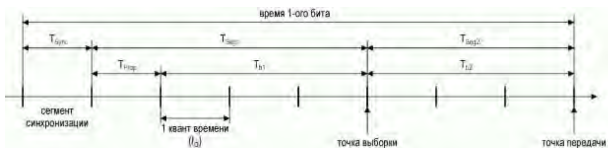
Рисунок 23.22 – Структура одного бита
