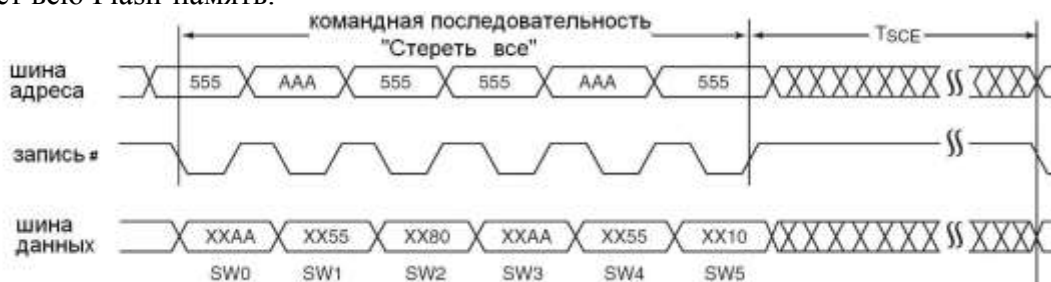
Рисунок 5.4 – Командная последовательность «Стереть все».
