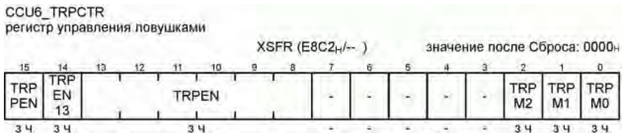
Рисунок 18.62– Формат регистра CCU6_TRPCTR
