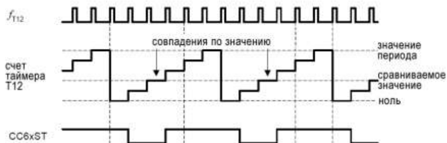
Рисунок 18.13 – Операция сравнения, режим «пила»
