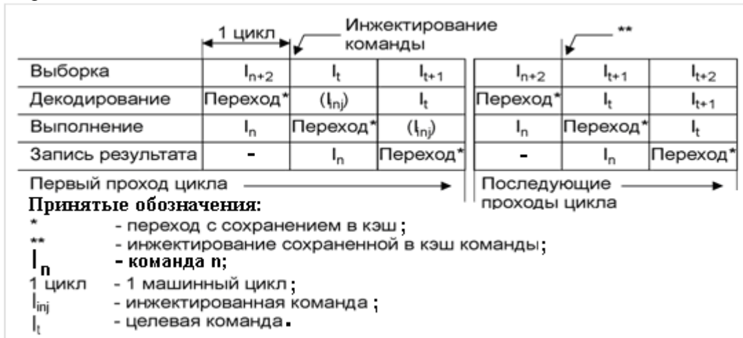
Рисунок 3.8 – Выполнение команд перехода с сохранением в кэш
