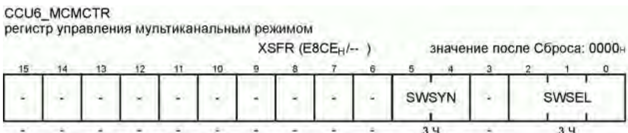
Рисунок 18.52 – Формат регистра CCU6_MCMCTR
