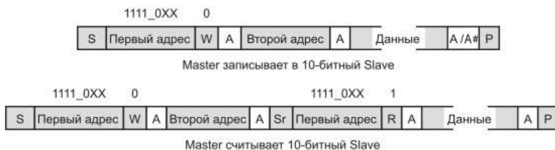
Рисунок 22.8 – 10-битная адресация Slave
