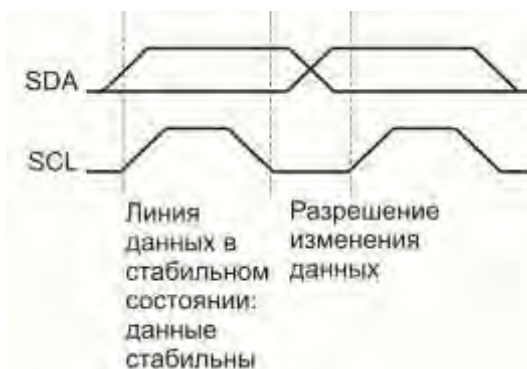
Рисунок 22.2 – Передача бита данных
