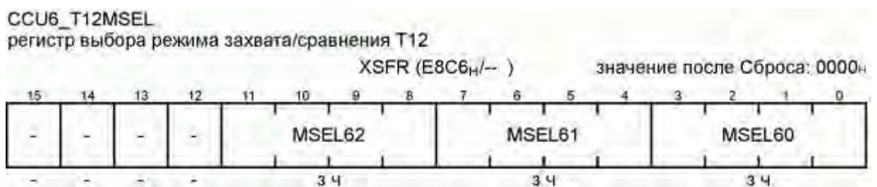
Рисунок 18.24 – Формат регистра выбора CCU6_T12MSEL режима захвата/сравнения
