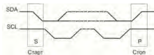
Рисунок 22.3 – Состояния «Старт» и «Стоп»
