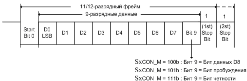
Рисунок 20.8 – Асинхронный 9-битный фрейм
