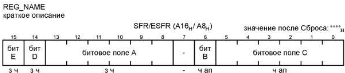
Рисунок 3.3 – Пример представления формата 16-разрядного регистра
