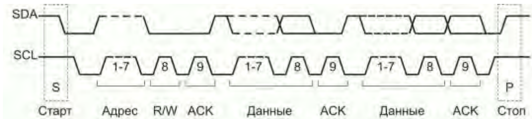
Рисунок 22.7 – Завершенная передача данных
