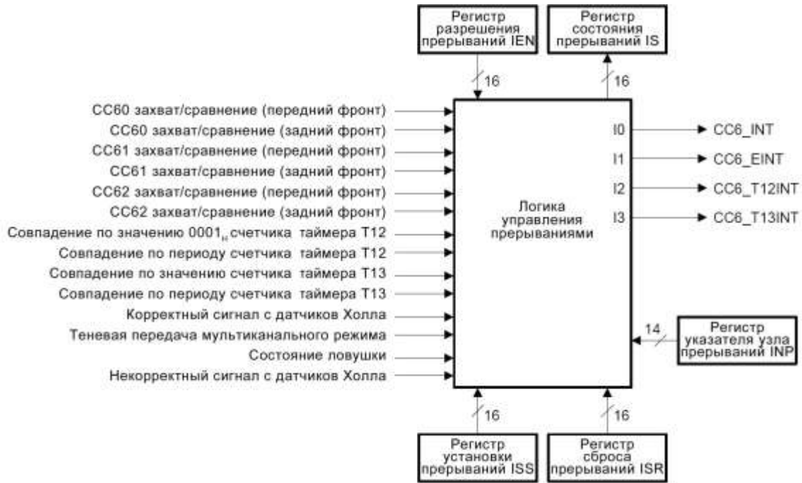
Рисунок 18.69 – Блок обработки прерываний
