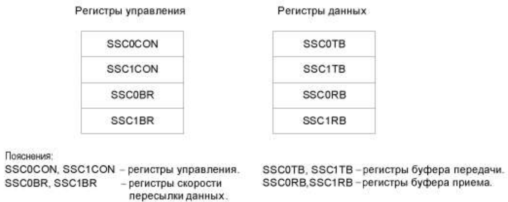
Рисунок 21.2 – Регистры высокоскоростных последовательных интерфейсов SSC0 и SSC1
