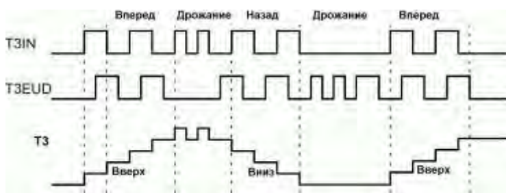
Рисунок 14.11 – Пример работы таймера T3 в режиме внешнего инкрементирования T3I = 001_B
