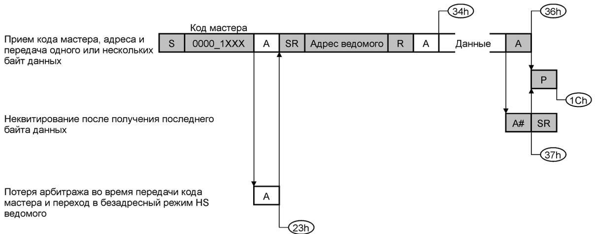
Рисунок 16.23 – Режим HS ведомого передатчика
