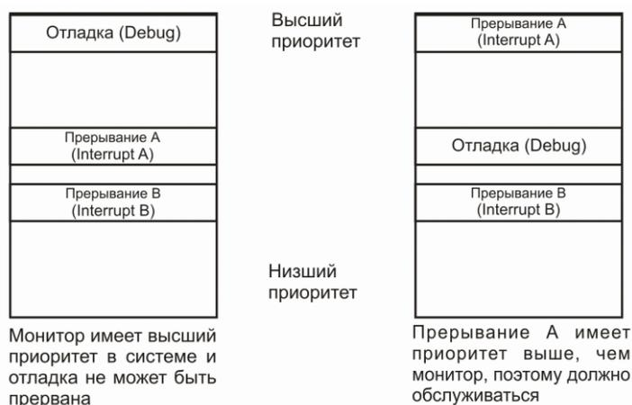
Рисунок 20.4 – Простая и расширенная модели отладки
