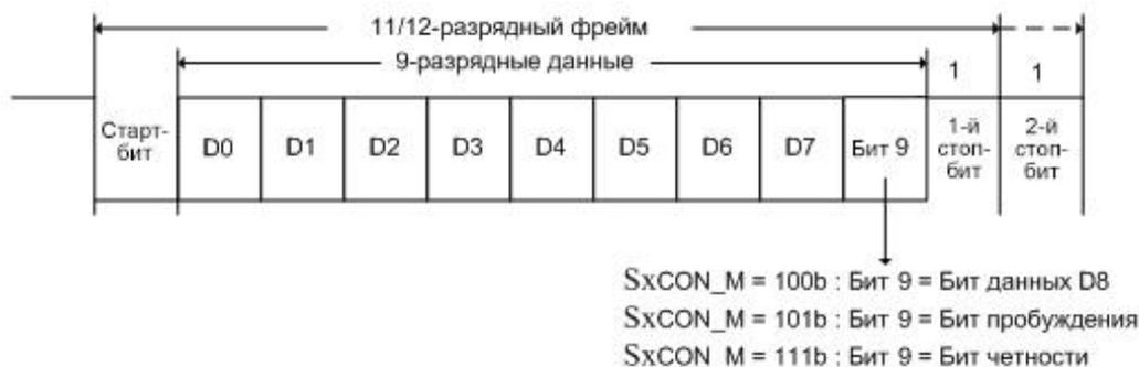
Рисунок 14.5 – Асинхронный 9-битный фрейм (младшим битом вперед)
