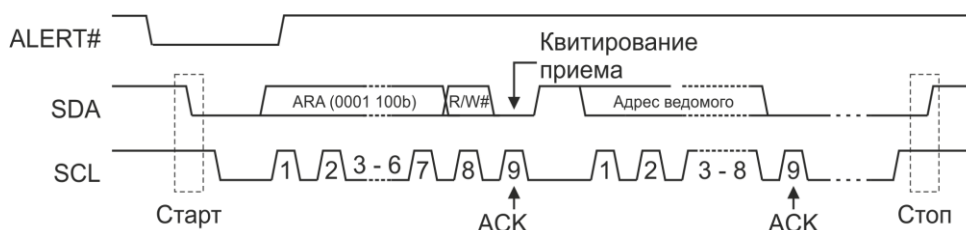
Рисунок 17.9 – Передача адреса отклика на сигнал предупреждения
