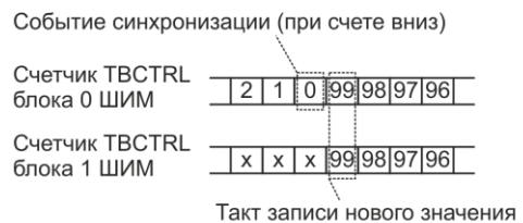
Рисунок 14.3 – Схема и особенности синхронизации модулей ШИМ
