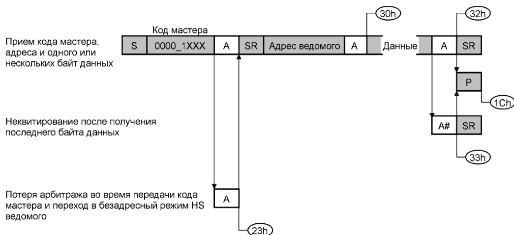
Рисунок 17.21 – Режим HS ведомого приемника
