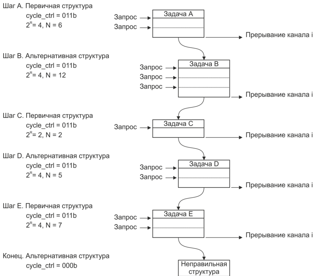
Рисунок 8.3 – Пример функционирования контроллера в режиме «пинг-понг»
