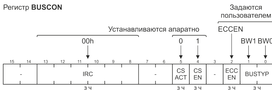
Рисунок 5.2 – Загрузка регистра BUSCON при выходе микроконтроллера из состояния сброса
