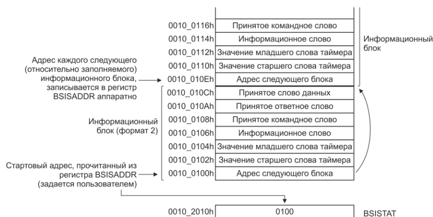
Рисунок 19.4 – Пример заполнения SFR1 в режиме монитора шины
