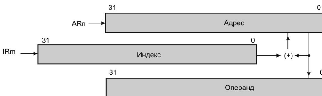
Рисунок 5.15 – Косвенная адресация с последующим прибавлением индекса и модификацией
