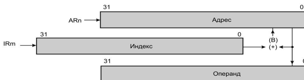
Рисунок 5.19 – Косвенная адресация с последующим прибавлением индекса и битреверсной модификацией
