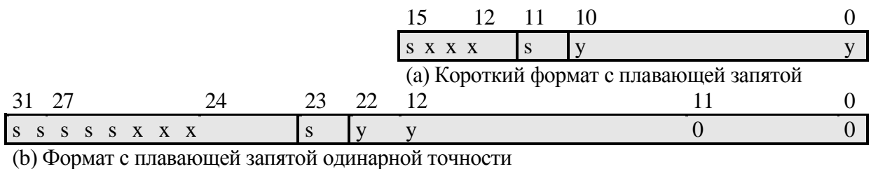
Рисунок 4.9 – Преобразование короткого формата с плавающей запятой в формат с плавающей запятой одинарной точности
