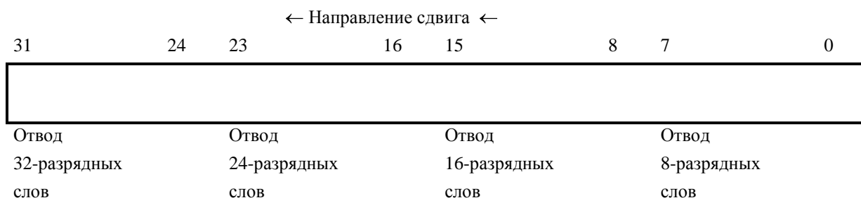
Рисунок 8.3 – Работа сдвигового регистра передачи
