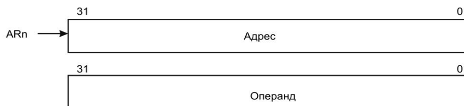
Рисунок 5.2 – Косвенная адресация через вспомогательный регистр
