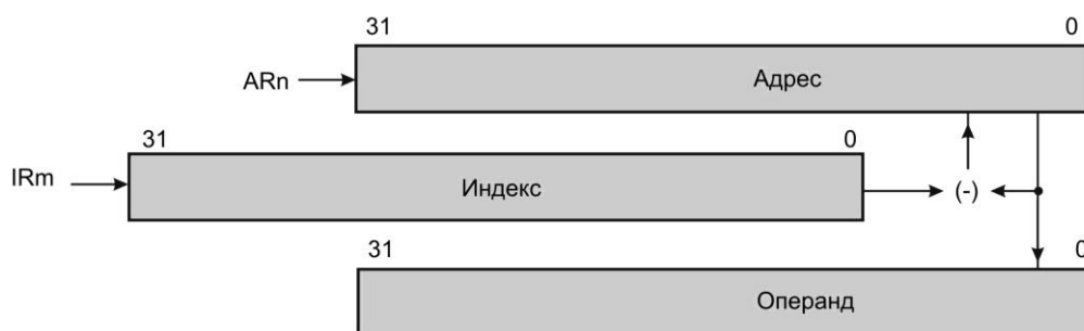
Рисунок 5.16 – Косвенная адресация с последующим вычитанием индекса и модификацией
