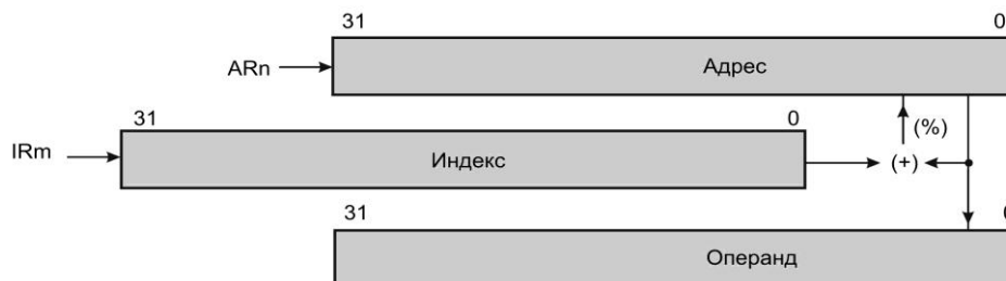
Рисунок 5.17 – Косвенная адресация с последующим сложением с индексом и циклической модификацией
