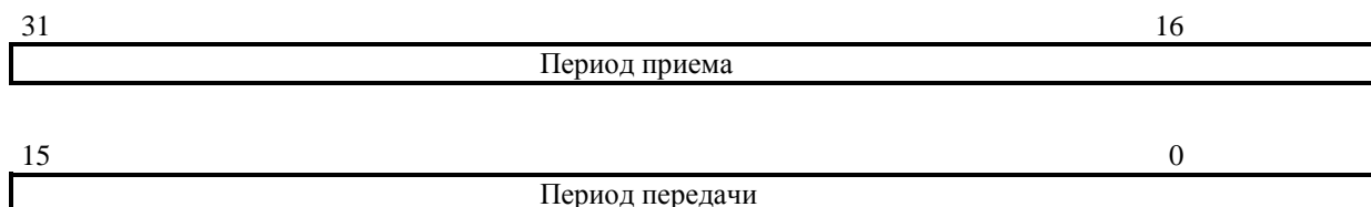
Рисунок 8.2 – Регистр периода таймера приема/передачи
