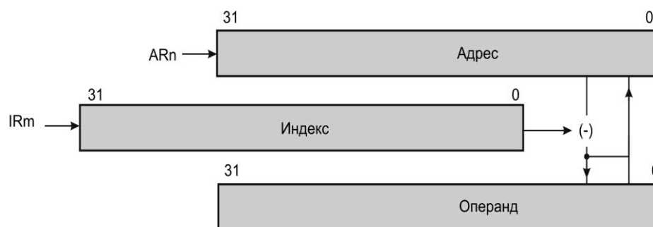
Рисунок 5.14 – Косвенная адресация с предварительным вычитанием индекса и модификацией
