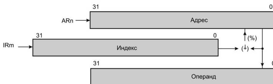
Рисунок 5.18 – Косвенная адресация с последующим вычитанием индекса и циклической модификацией
