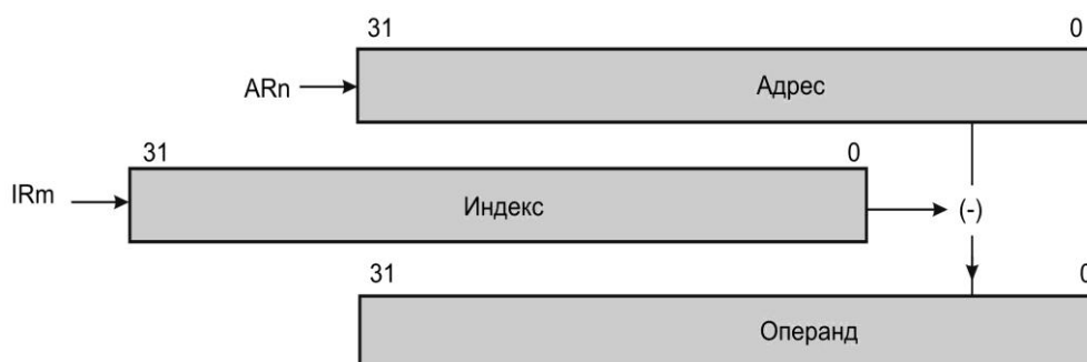
Рисунок 5.12 – Косвенная адресация с предварительным вычитанием индекса
