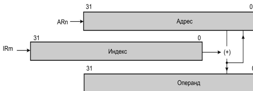
Рисунок 5.13 – Косвенная адресация с предварительным сложением индекса и модификацией
