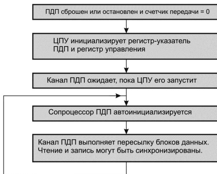
Рисунок 5.122 – Работа канала ПДП в режиме TRANSFER MODE = 11_2 (метод автоинициализации 2а)
