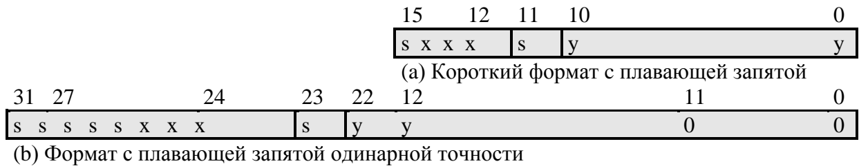
Рисунок 5.28 – Преобразование короткого формата с плавающей запятой в формат с плавающей запятой одинарной точности
