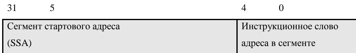
Рисунок 5.18 – Адресное разделение для контрольного алгоритма кэш
