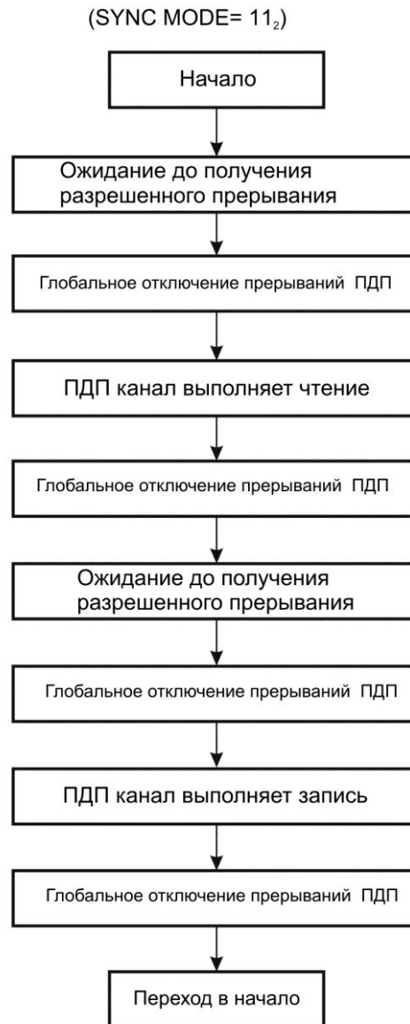
Рисунок 5.137 – Синхронизация источника и приемника ПДП в основном режиме
