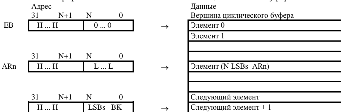
Рисунок 5.51 – Реализация циклического буфера
