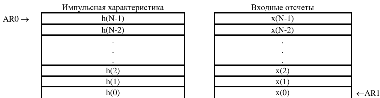
Рисунок 5.53 – Структура данных для КИХ-фильтров
