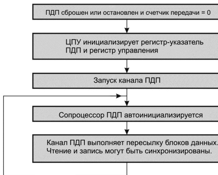
Рисунок 5.120 – Работа канала ПДП в режиме TRANSFER MODE = 10 2 (метод автоинициализации 1а)
