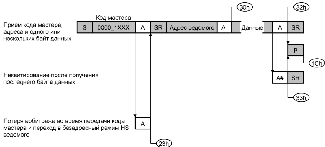
Рисунок 17.21 – Режим HS ведомого приемника
