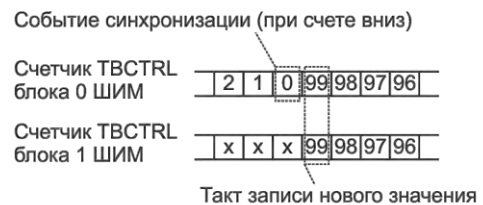
Рисунок 14.3 – Схема и особенности синхронизации модулей ШИМ
