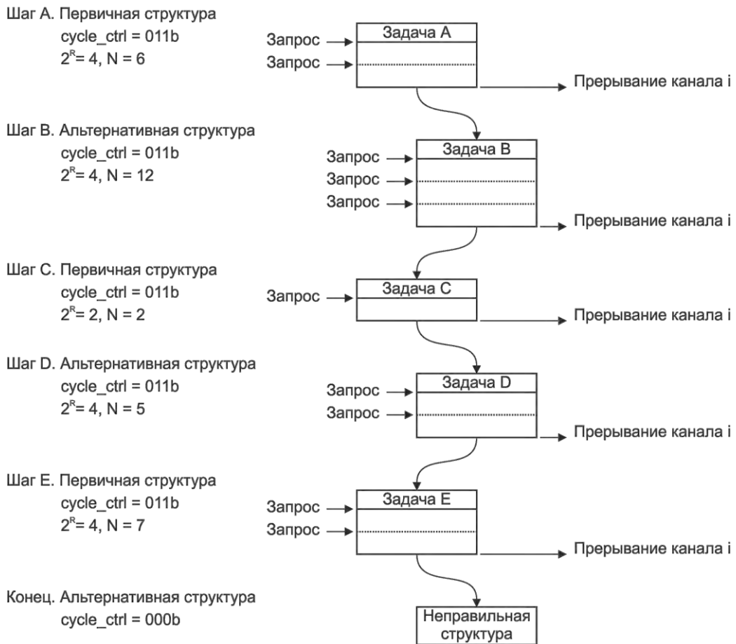
Рисунок 8.3 – Пример функционирования контроллера в режиме «пинг-понг»
