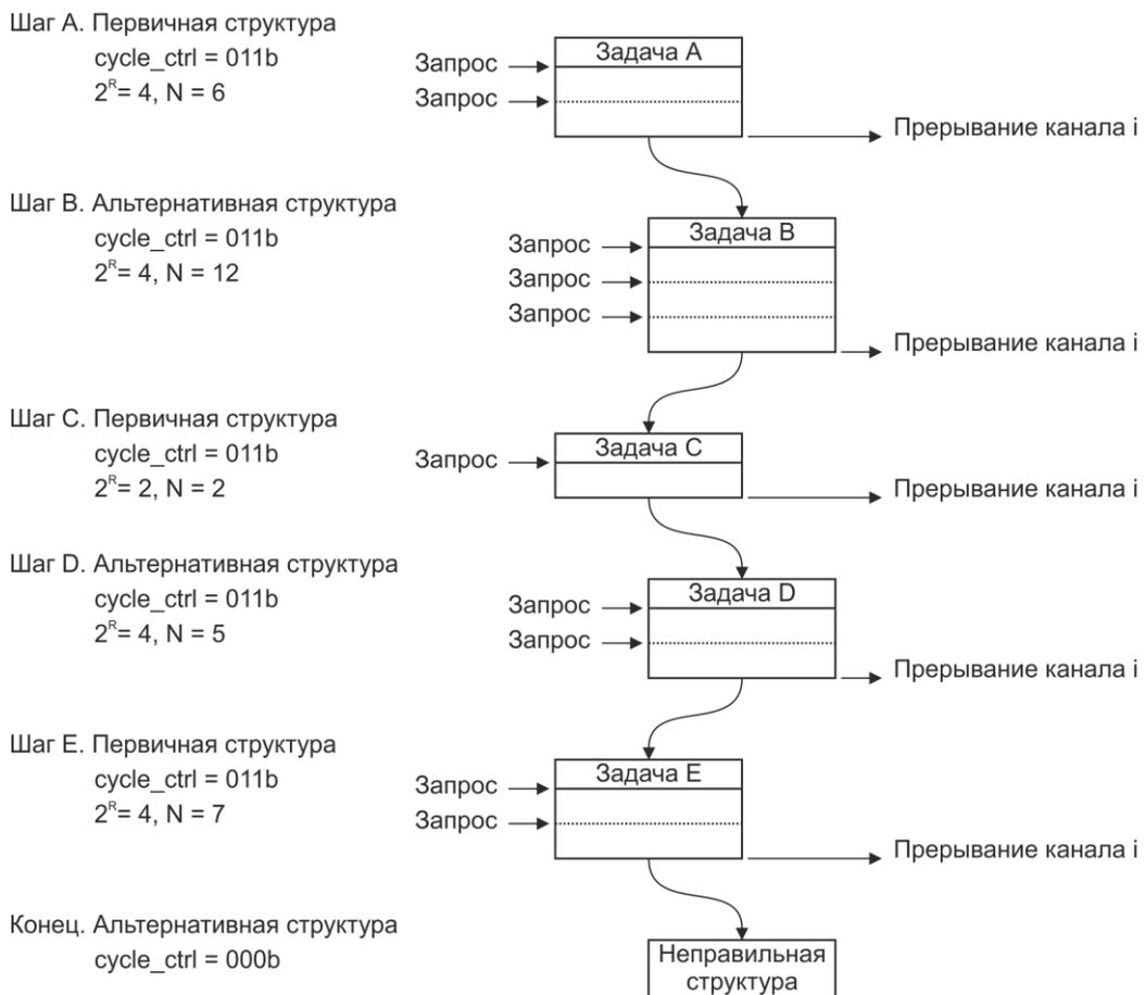
Рисунок 8.3 – Пример функционирования контроллера в режиме «пинг-понг»
