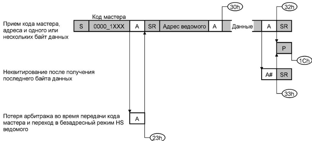
Рисунок 17.21 – Режим HS ведомого приемника
