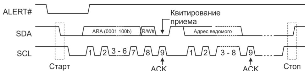
Рисунок 17.9 – Передача адреса отклика на сигнал предупреждения
