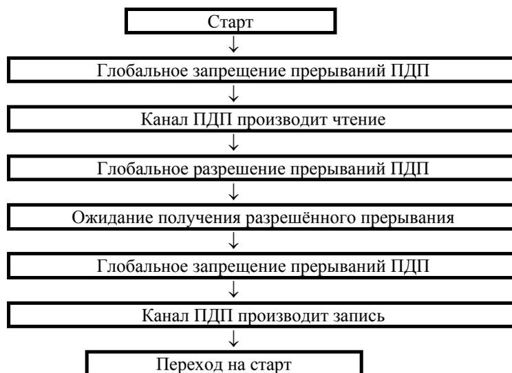
Рисунок А.8.9 – Синхронизация по назначению
