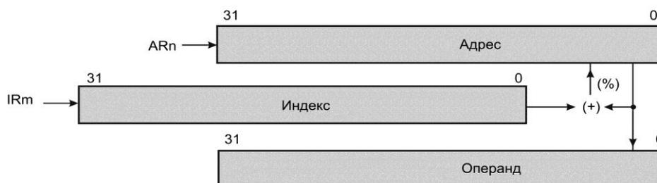
Рисунок А.5.17 – Косвенная адресация с последующим сложением с индексом и циклической модификацией
