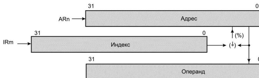
Рисунок А.5.18 – Косвенная адресация с последующим вычитанием индекса и циклической модификацией
