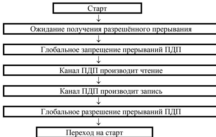
Рисунок А.8.8 – Синхронизация источника
