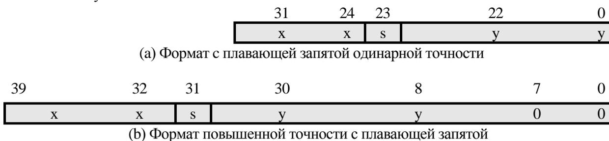
Рисунок А.4.11 – Преобразование формата с плавающей запятой одинарной точности в формат с плавающей запятой повышенной точности
