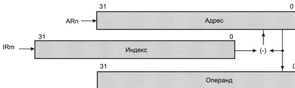
Рисунок А.5.16 – Косвенная адресация с последующим вычитанием индекса и модификацией
