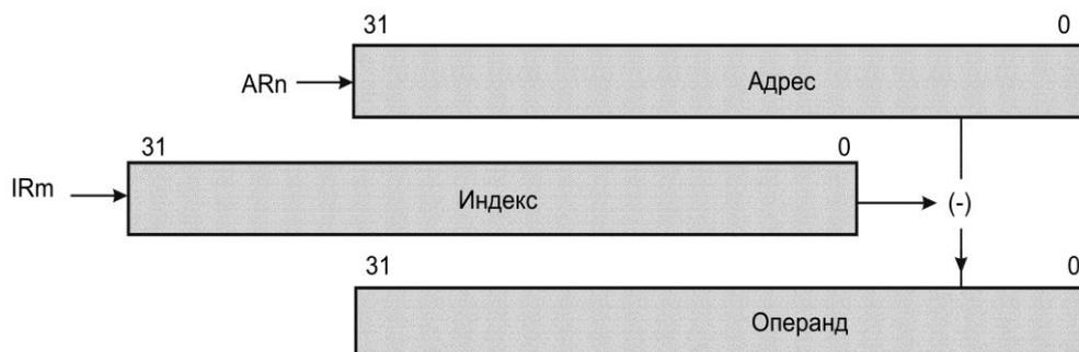
Рисунок А.5.12 – Косвенная адресация с предварительным вычитанием индекса
