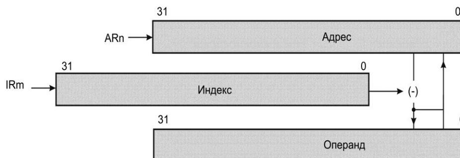
Рисунок А.5.14 – Косвенная адресация с предварительным вычитанием индекса и модификацией
