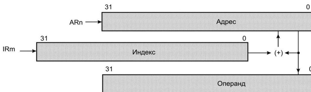
Рисунок А.5.15 – Косвенная адресация с последующим прибавлением индекса и модификацией
