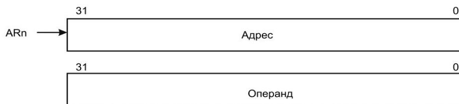
Рисунок А.5.2 – Косвенная адресация через вспомогательный регистр
