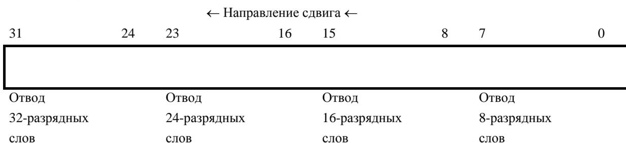
Рисунок А.8.3 – Работа сдвигового регистра передачи
