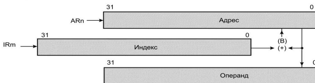
Рисунок А.5.19 – Косвенная адресация с последующим прибавлением индекса и битреверсной модификацией
