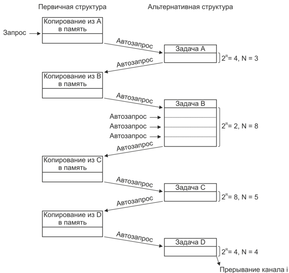
Рисунок 8.4 – Пример функционирования контроллера в режиме «разборка-сборка»
