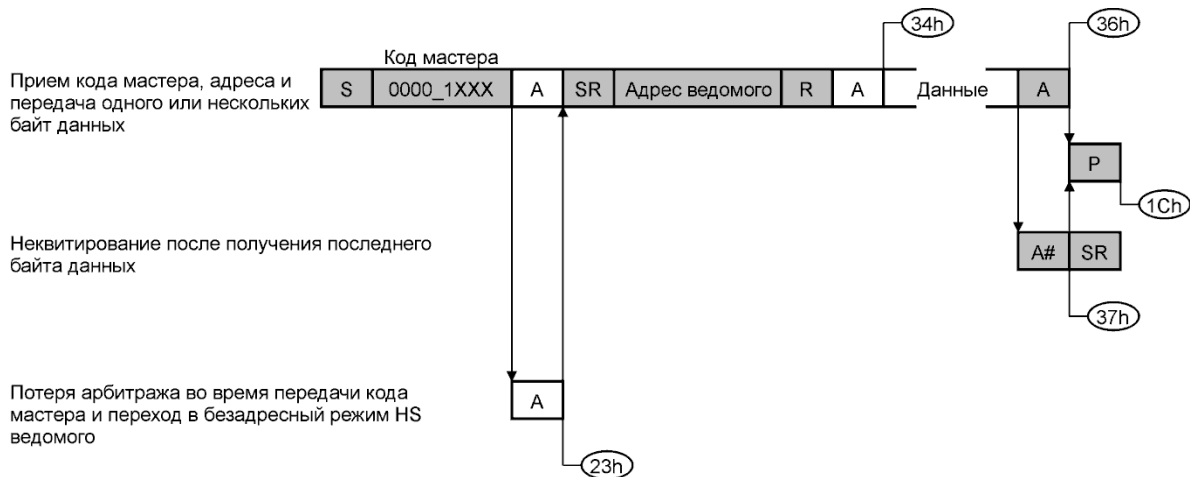
Рисунок 17.23 – Режим HS ведомого передатчика
