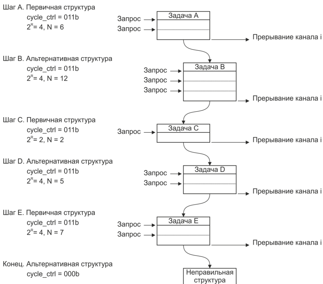
Рисунок 8.3 – Пример функционирования контроллера в режиме «пинг-понг»
