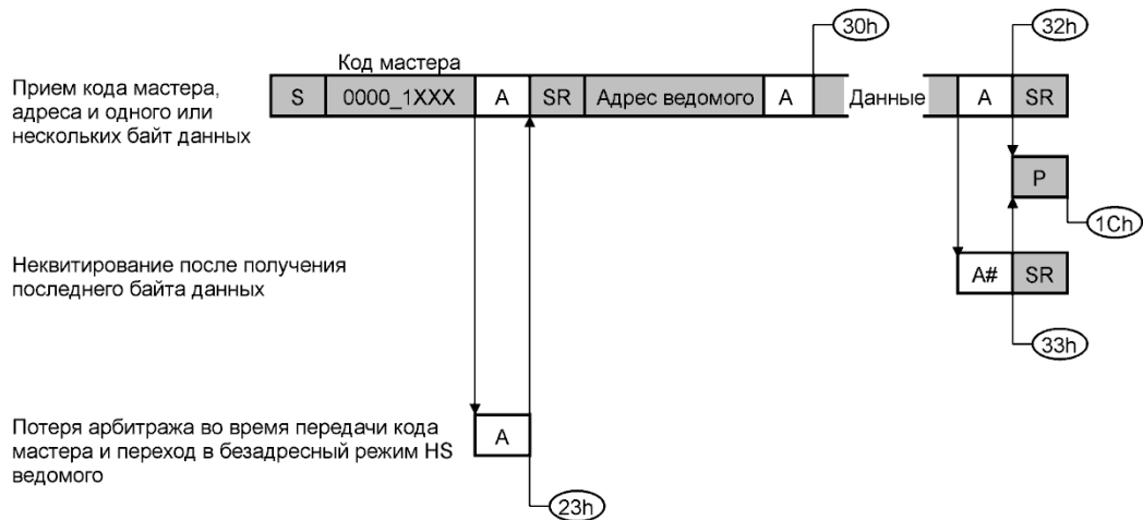
Рисунок 17.21 – Режим HS ведомого приемника
