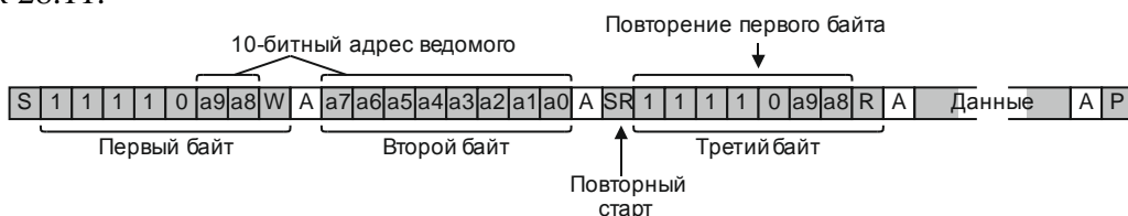
Рисунок 28.11 – Получение данных от ведомого с 10-битным адресом
