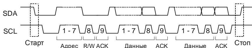
Рисунок 28.8 – Передача данных с 7-битной адресацией
