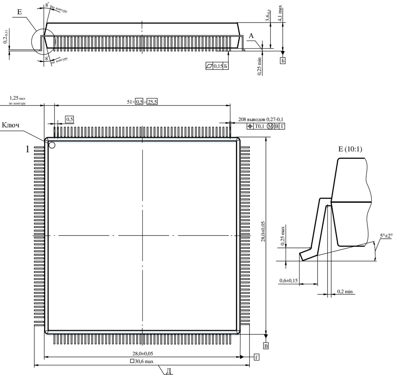
1 Размеры Д выдержать до установки микросхемы потребителем.
