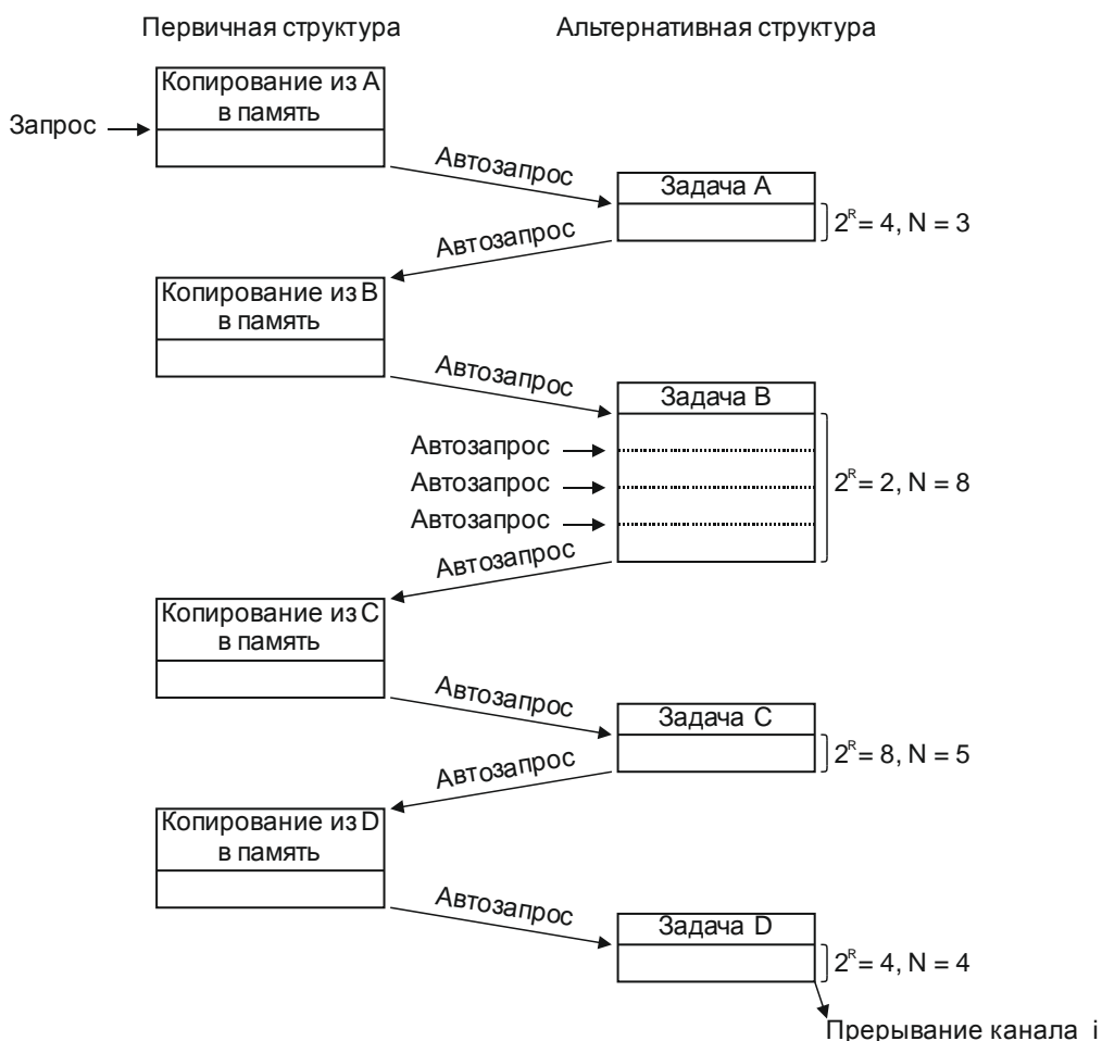
Рисунок 9.4 – Пример функционирования контроллера DMA в режиме «разборка-сборка»
