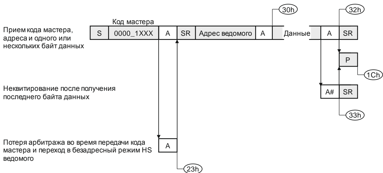
Рисунок 28.21 – Режим HS ведомого приемника
