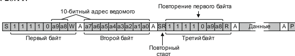
Рисунок 28.11 – Получение данных от ведомого с 10-битным адресом
