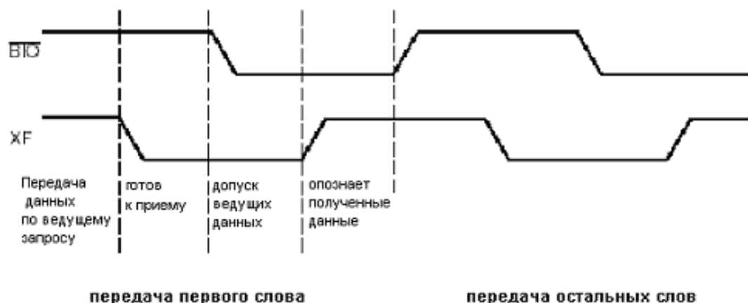
Рисунок 4.27 - Протокол установления связи
