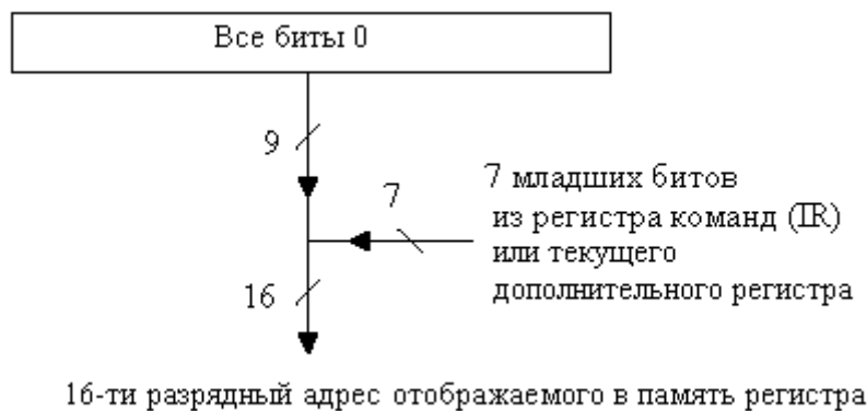
Рисунок 4.20 – Адресация регистров, отображаемых в память
