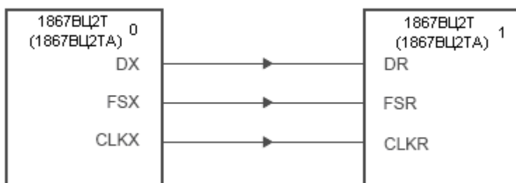
Рисунок 4.40 - Однонаправленная передача по последовательному порту.
