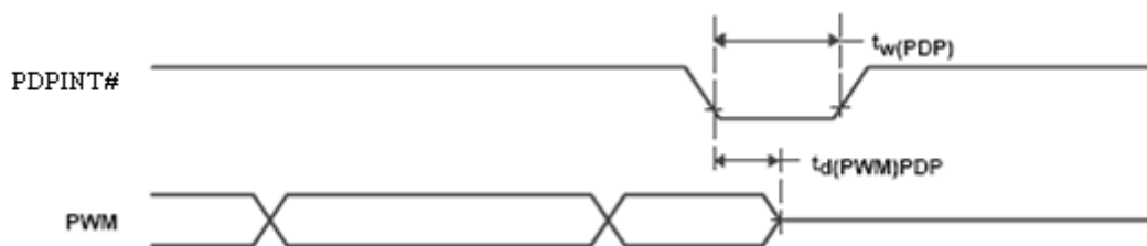
Рисунок 37 – Временная диаграмма прерывания от схемы защиты по питанию
