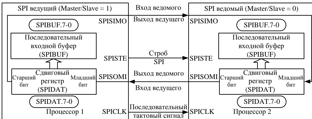
Рисунок 113 – Соединение ведущий (Master)/ведомый (Slave) модулей SPI (условие четырех контактов)
