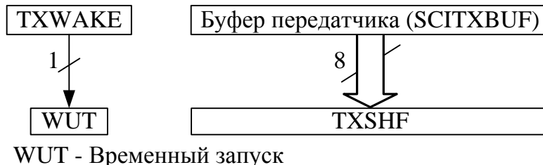
Рисунок 94 – TXSHF и WUT с двойной буферизацией
