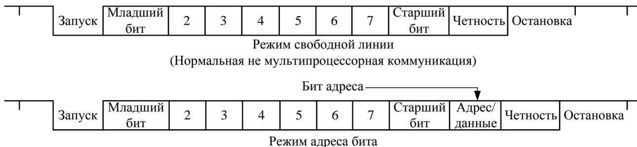
Рисунок 97 – Типичные форматы фреймов данных модуля SCI
