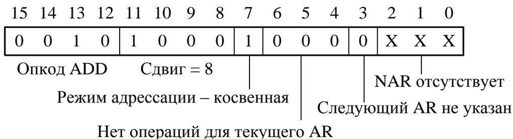
Рисунок 271 – Косвенная адресация без инкрементирования или декрементирования
