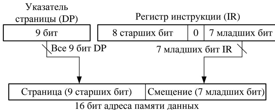
Рисунок 266 – Формирование адреса данных в режиме прямой адресации
