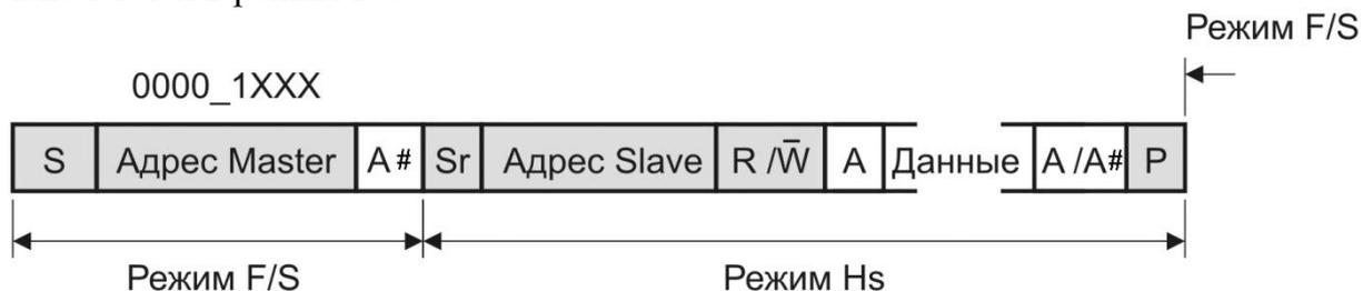
Рисунок 374 – Высокоскоростной режим (Hs)
