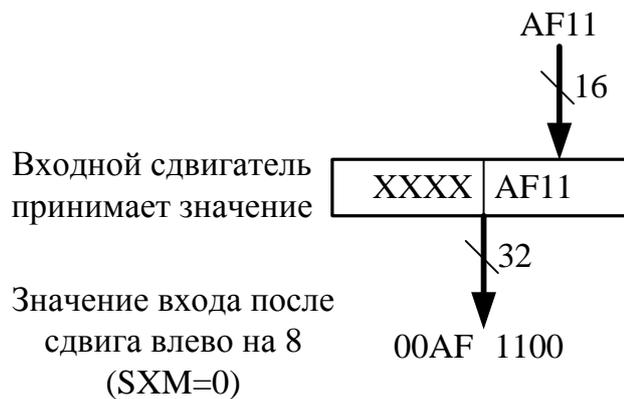
Рисунок 231 – Работа входного сдвигателя для  $SXM = 0$
