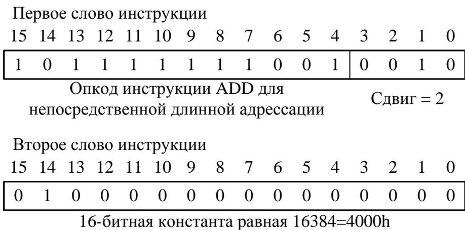
Рисунок 263 – Два слова загружаются последовательно в регистр инструкции в примере 2
