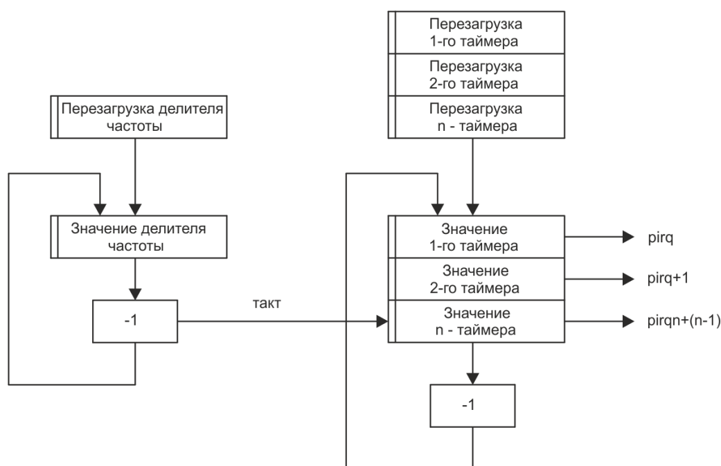
Рисунок 4.13.1 – Структурная схема блока таймеров общего назначения
