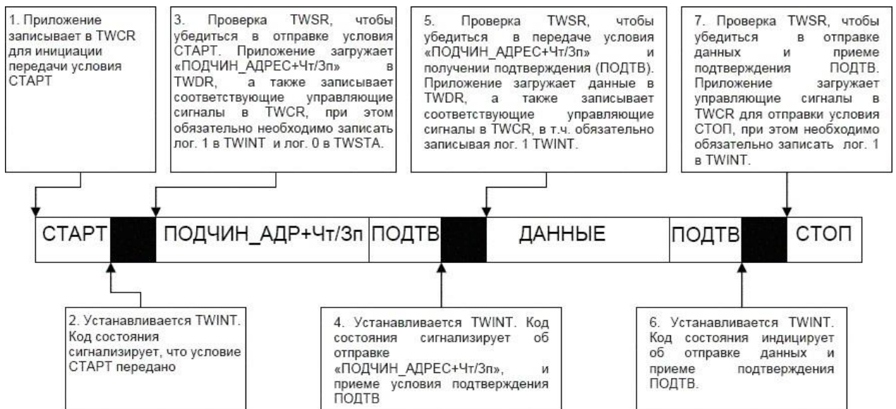
Рисунок 3.83 – Последовательность обслуживания TWI при типичной передаче
