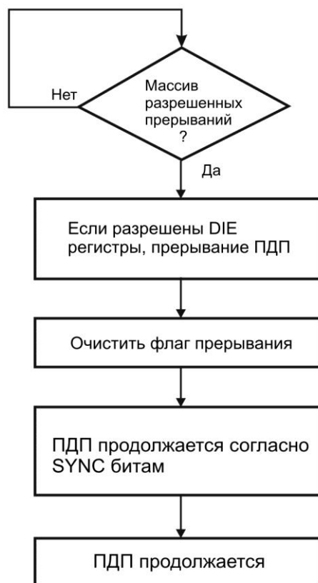
Рисунок 5.63 – Процесс прерывания ПДП
