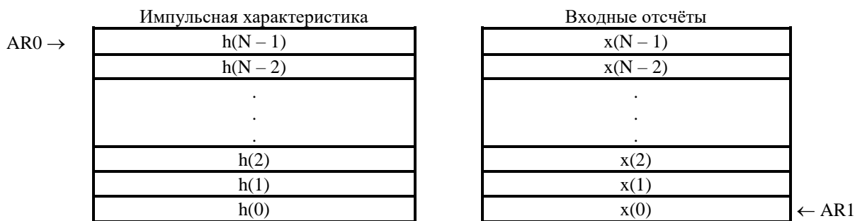
Рисунок 5.53 – Структура данных для КИХ-фильтров
