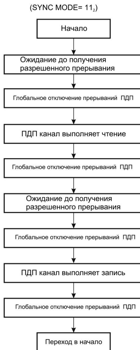
Рисунок 5.137 – Синхронизация источника и приёмника ПДП в основном режиме
