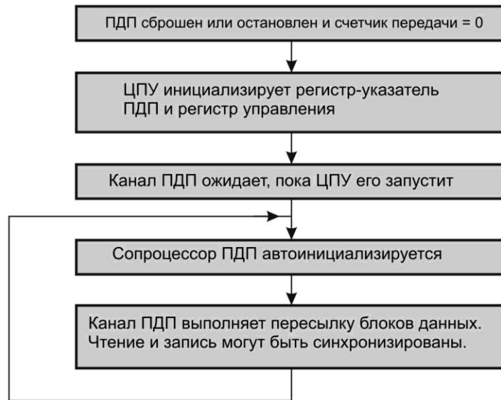
Рисунок 5.122 – Работа канала ПДП в режиме TRANSFER MODE = 11 2 (метод автоинициализации 2а)
