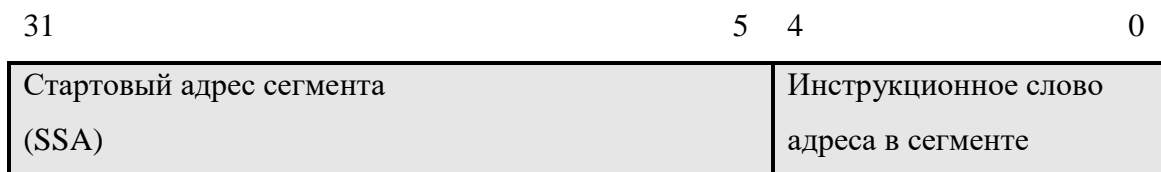
Рисунок 5.18 – Адресное разделение для контрольного алгоритма кэш
