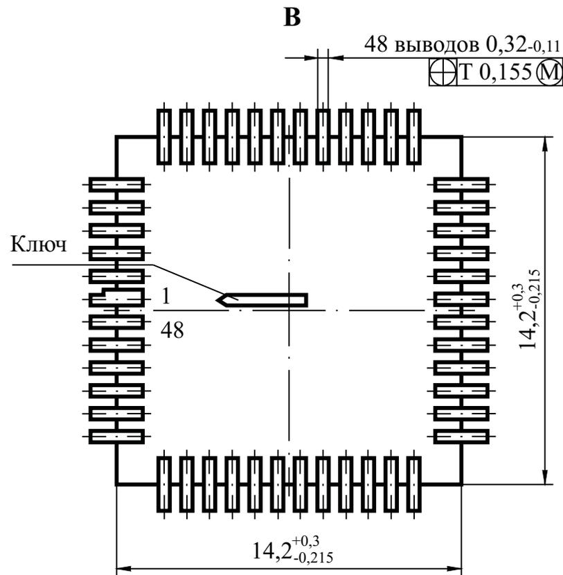
1 А – длина вывода, в пределах которой производится контроль смещения плоскостей симметрии выводов от номинального расположения.
