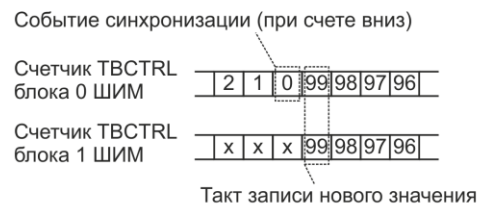
Рисунок 14.3 – Схема и особенности синхронизации модулей ШИМ
