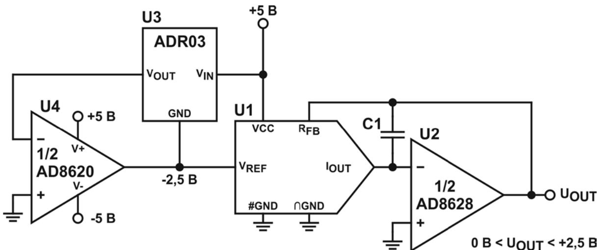
Рисунок 4.2 – Схема включения микросхемы K1273HA03A4 с отрицательным опорным напряжением и положительным выходным напряжением
