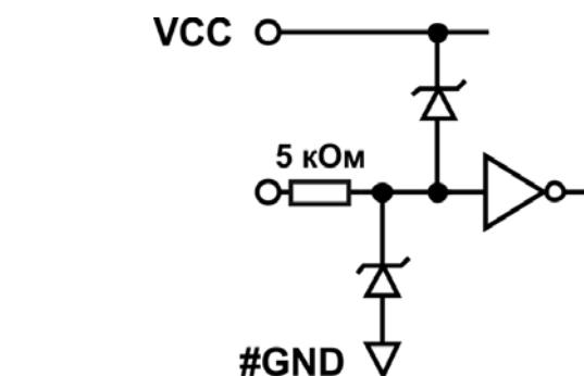
Рисунок 3.5 – Упрощенная схема ESD защиты микросхемы K1273HA03A4
