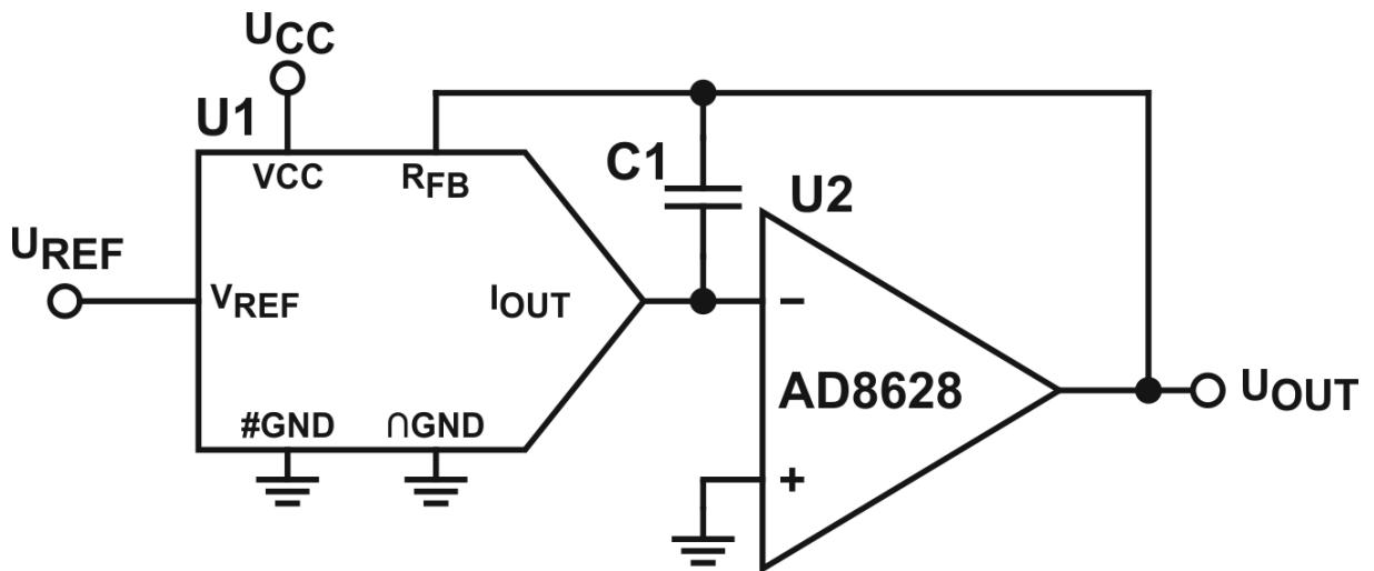
Рисунок 4.1 – Типовая схема включения микросхемы K1273HA03A4
