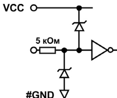
Рисунок 3.5 – Упрощенная схема ESD защиты микросхемы К1273НА03А4
