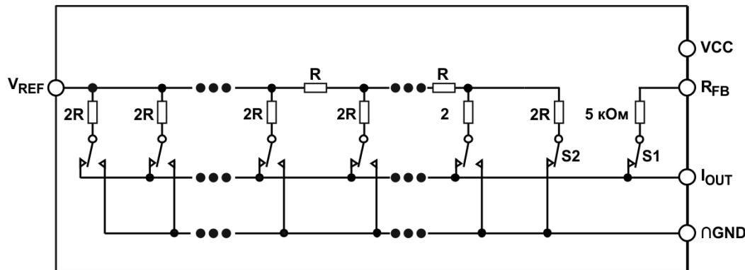
Рисунок 3.2 – Упрощенная схема резистивной матрицы ЦАП
