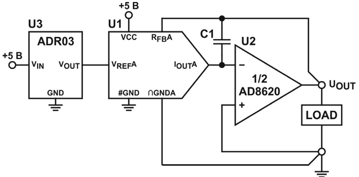
Рисунок 3.3 – Схема включения канала А микросхемы К1273НА03А4
