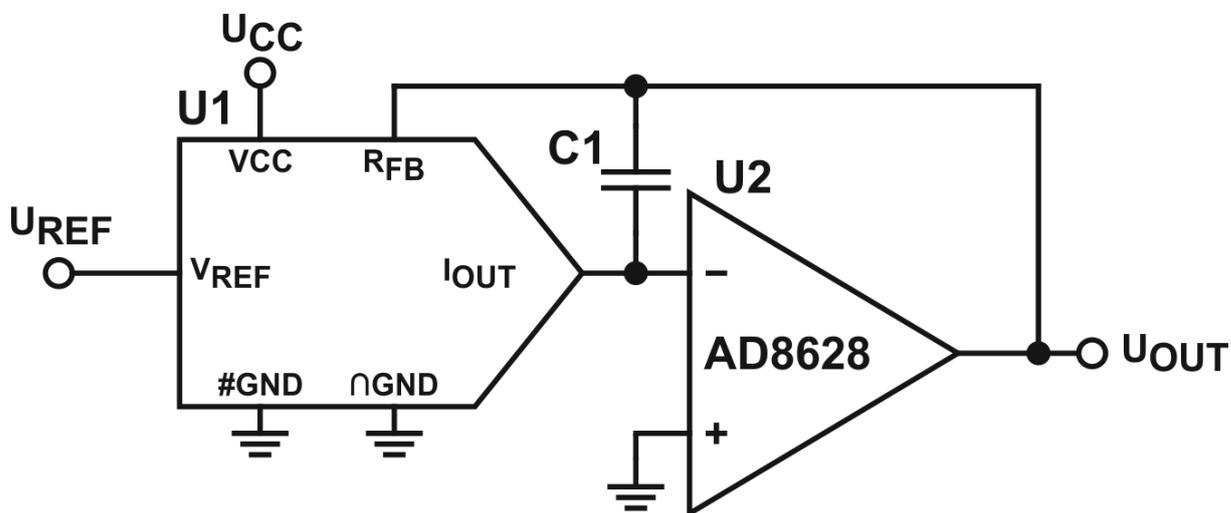
Рисунок 4.1 – Типовая схема включения микросхемы К1273НА03А4
