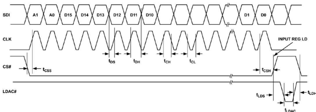
Рисунок 3.4 – Временная диаграмма работы последовательного интерфейса микросхемы K1273HA03A4
