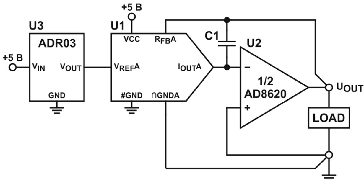
Рисунок 3.3 – Схема включения канала А микросхемы K1273HA03A4
