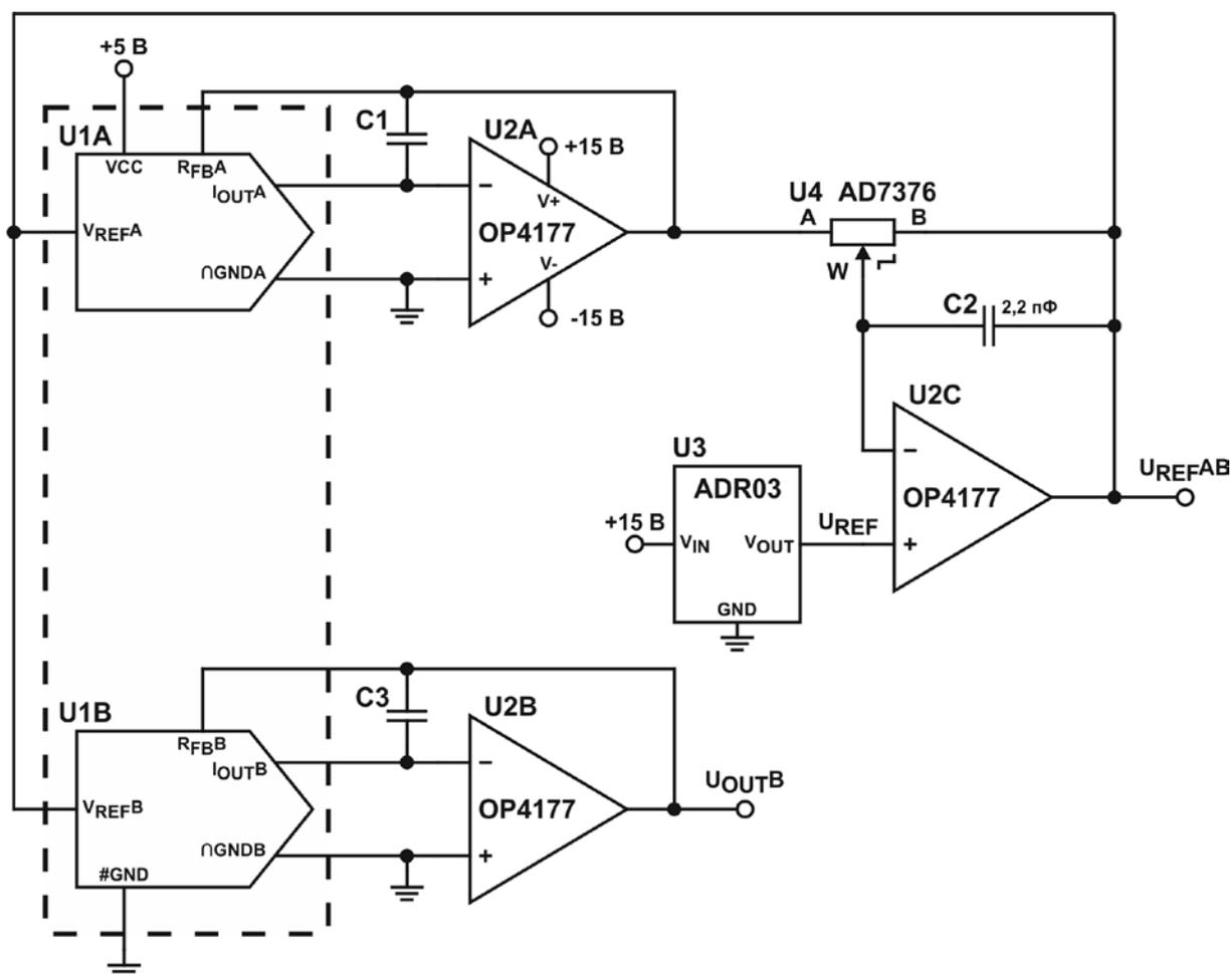
Рисунок 4.5 – Микросхема K1273HA03A4 с программируемым входным опорным напряжением
