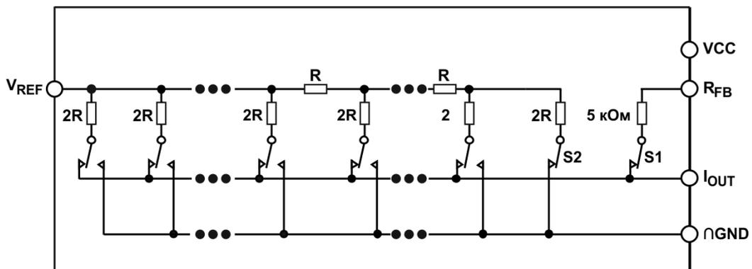
Рисунок 3.2 – Упрощенная схема резистивной матрицы ЦАП
