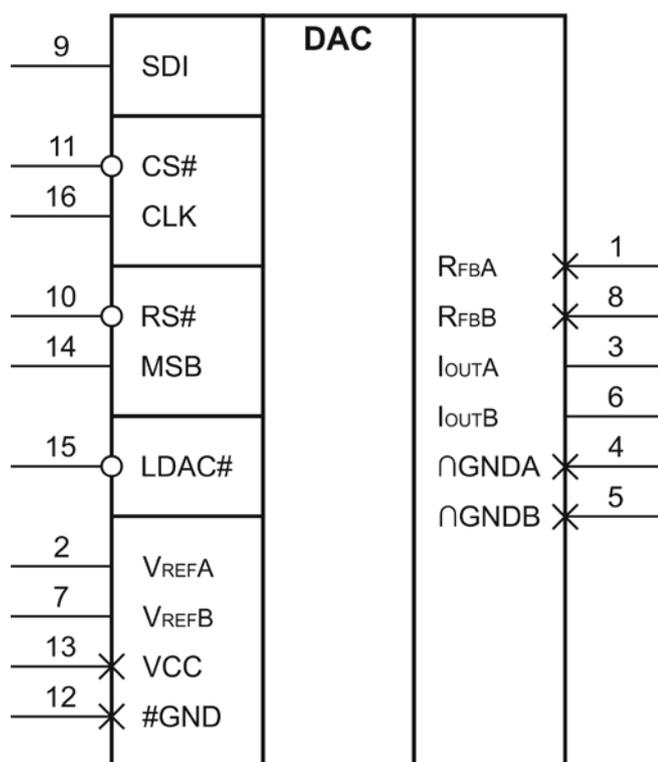
Рисунок 2.1 – Условное графическое обозначение микросхемы K1273HA03A4
