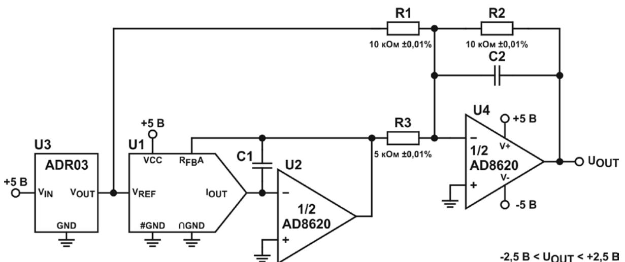
Рисунок 4.3 – Схема четырехквадрантного умножения
