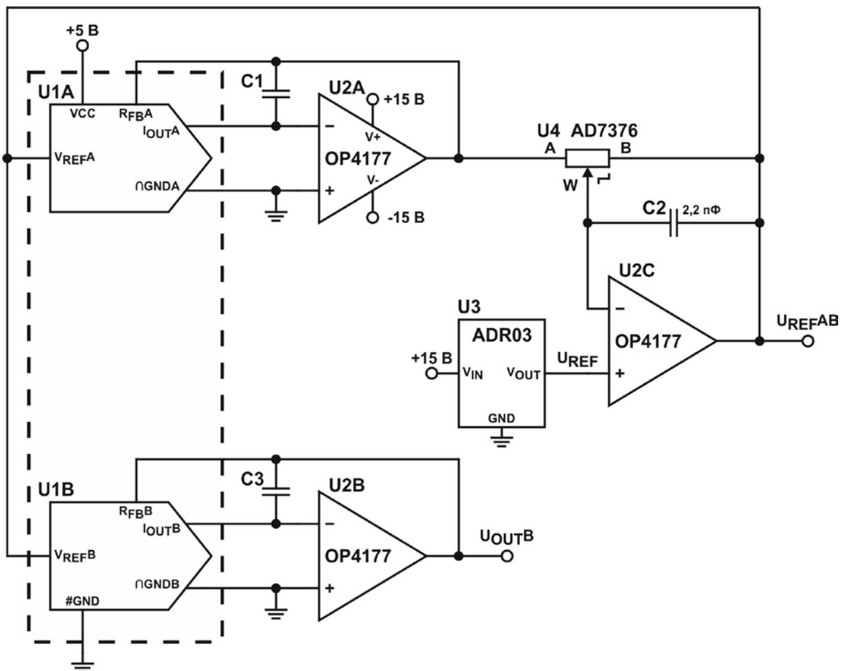
Рисунок 4.5 – Микросхема K1273НА03А4 с программируемым входным опорным напряжением
