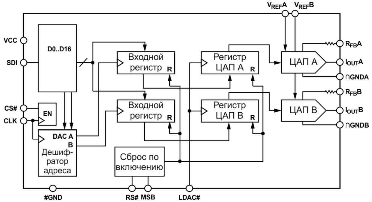
Рисунок 3.1 – Структурная схема микросхемы K1273HA03A4
