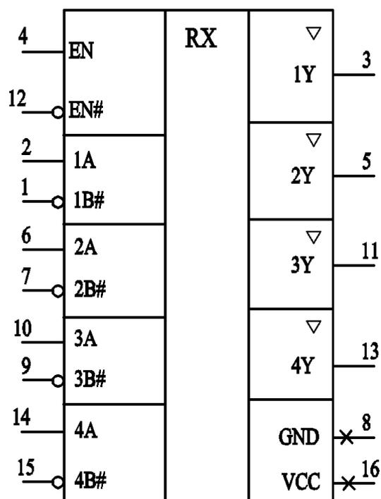
Рисунок 1 – Условное графическое обозначение ИС K5537BB025
