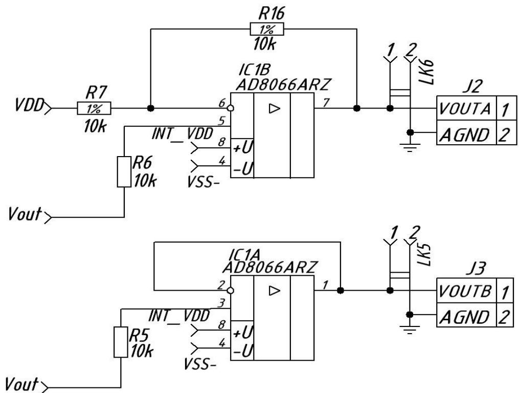
Рисунок 5 – Электрическая схема выходных цепей демонстрационной платы
