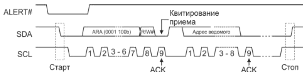
Рисунок 17.9 – Передача адреса отклика на сигнал предупреждения
