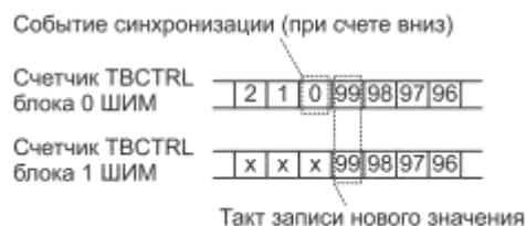
Рисунок 14.3 – Схема и особенности синхронизации модулей ШИМ
