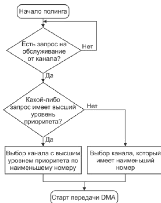
Рисунок 8.2 – Алгоритм выбора (полинга) следующего канала для обслуживания
