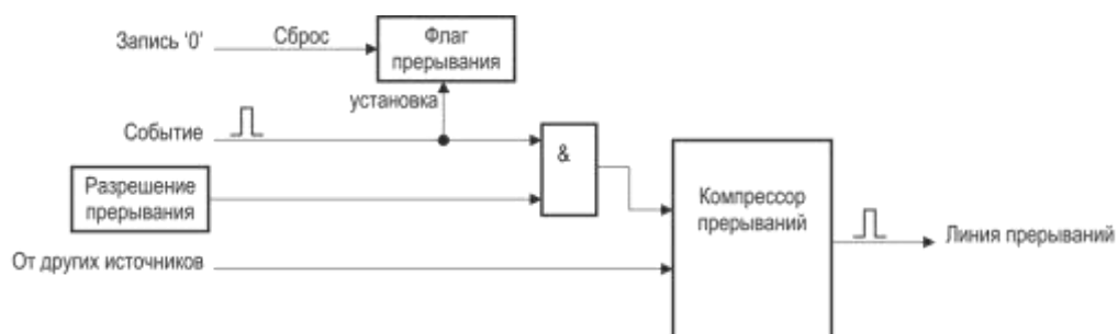
Рисунок 18.12 – Структура формирования запроса на прерывание
