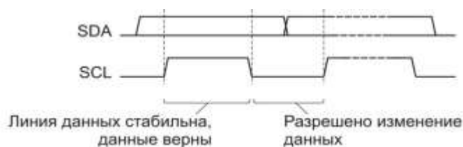
Рисунок 17.1 – Передача бита данных
