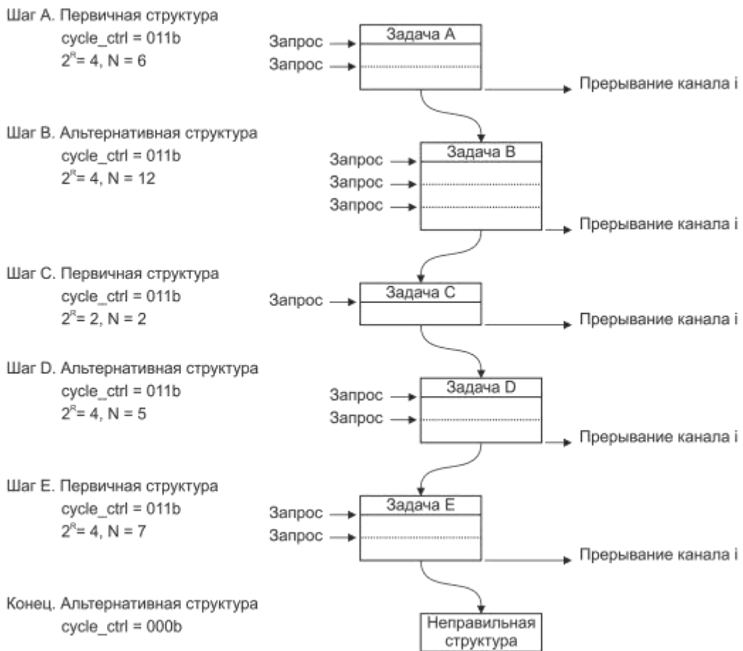
Рисунок 8.3 – Пример функционирования контроллера в режиме «пинг-понг»
