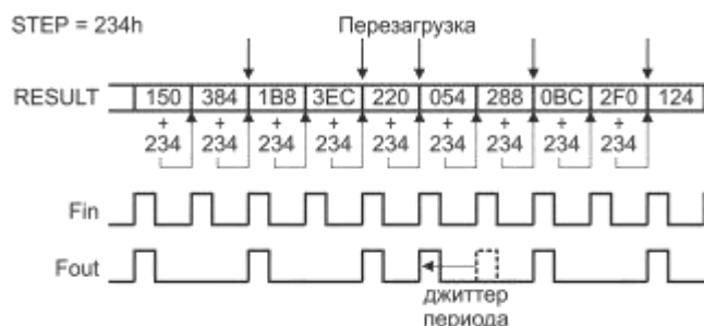
Рисунок 18.11 – Формирование сигнала с частотой f_{out} в режиме дробного деления
