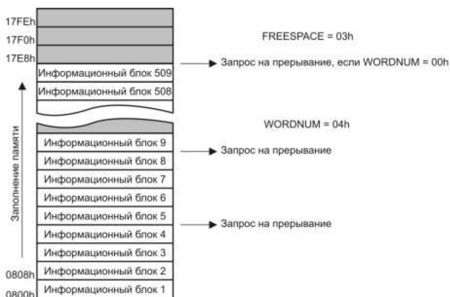
Рисунок 15.5 – Формирование запросов на прерывания при заполнении памяти
