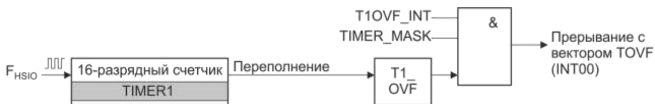
Рисунок 12.1 – Функциональная схема блока таймера 1
