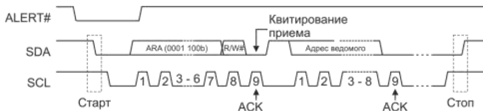
Рисунок 11.9 – Передача адреса отклика на сигнал предупреждения
