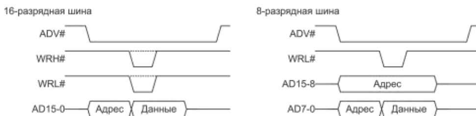
Рисунок 20.52 – Режим stroba достоверного адреса и записи
