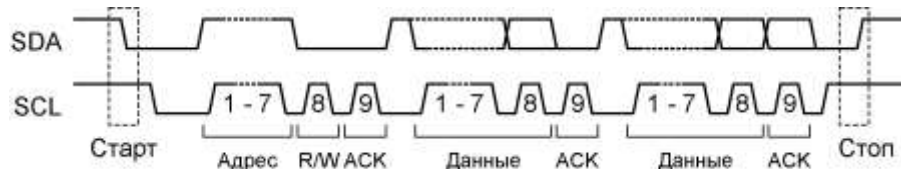
Рисунок 11.8 – Передача данных с 7-битной адресацией
