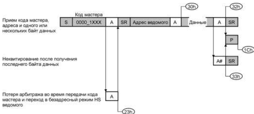
Рисунок 11.21 – Режим HS ведомого приемника
