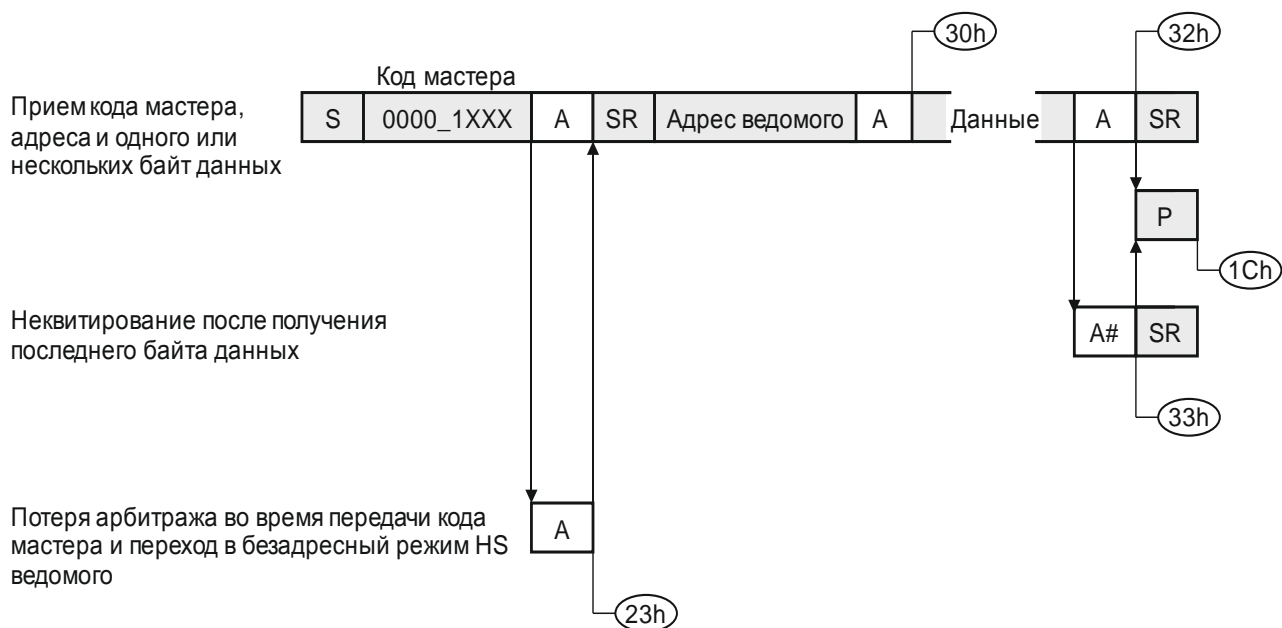
Рисунок 17.21 – Режим HS ведомого приемника
