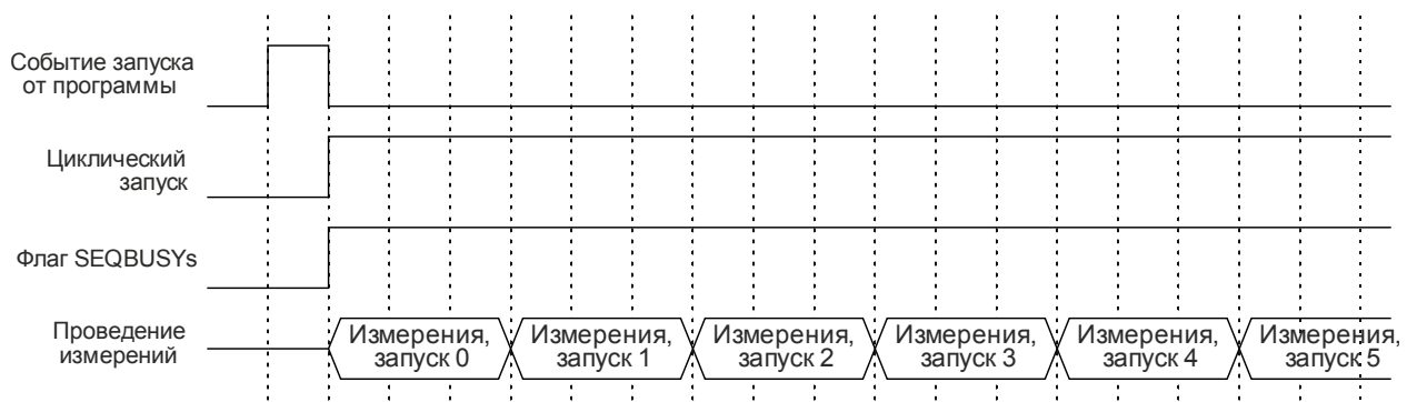
Рисунок 19.7 – Диаграммы работы секвенсора при циклическом запуске
