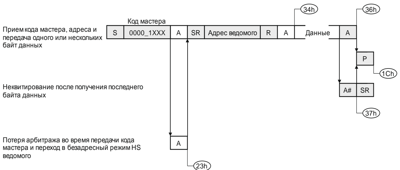
Рисунок 17.23 – Режим HS ведомого передатчика
