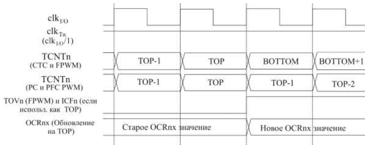
Рисунок 3.49 – Временная диаграмма таймера/счетчика без устройства предварительного деления частоты
