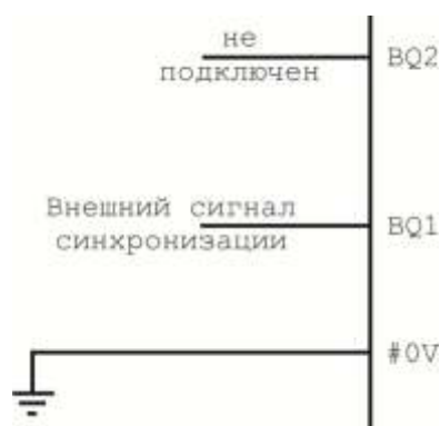
Рисунок 3.12 – Конфигурация при тактировании от внешнего генератора
