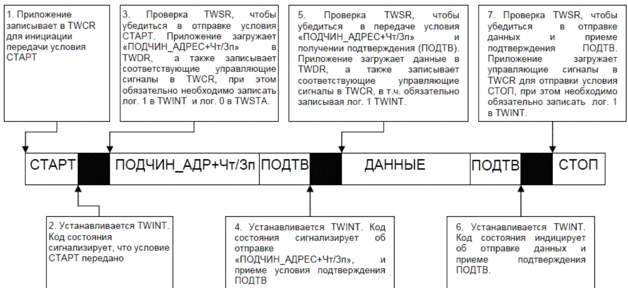
Рисунок 3.83 – Последовательность обслуживания TWI при типичной передаче
