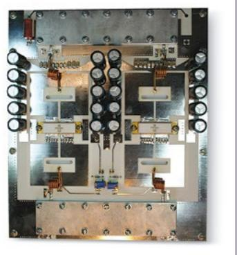
УСИЛИТЕЛИ МОЩНОСТИ ИМПУЛЬСНОГО РЕЖИМА ОВЧ-ДИАПАЗОНА
