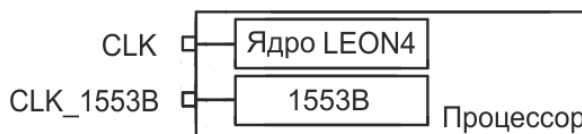
Рисунок 4.16.4 – Схема тактирования ядра микропроцессора и интерфейсов Mil-STD-1553B
