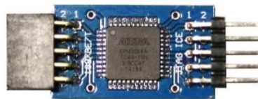
Рисунок 3 –Переходник КФДЛ.441461.009 для JTAG отладчика
