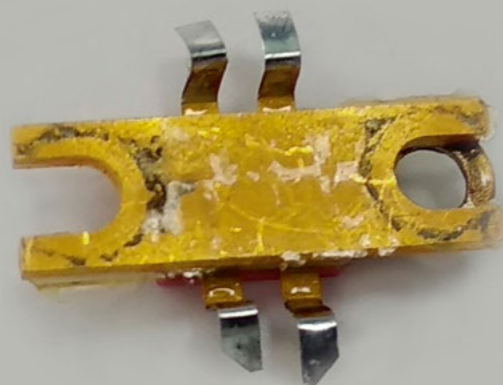
Рис. 9. Нижняя часть металлического теплоотвода транзистора со следами лака
