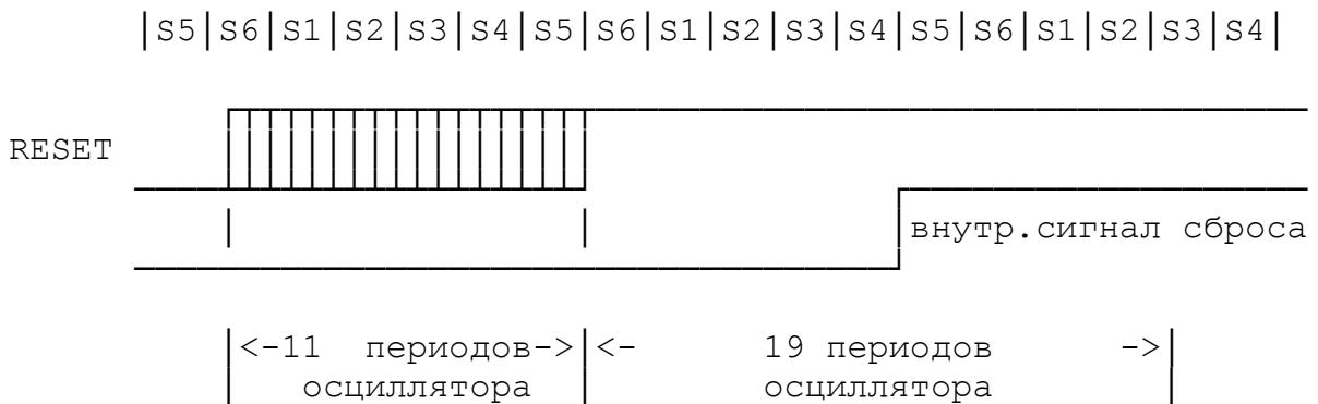
Рисунок 3 - Временные диаграммы сигналов ИМС при сбросе
