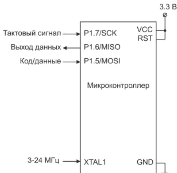
Рисунок 20.2 – Схема включения при последовательном программировании
