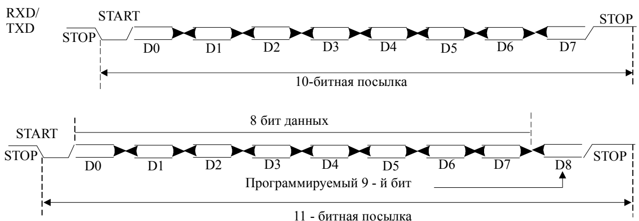
Рисунок 10.3.2 - Работа последовательного порта в режимах 1,2 и 3
