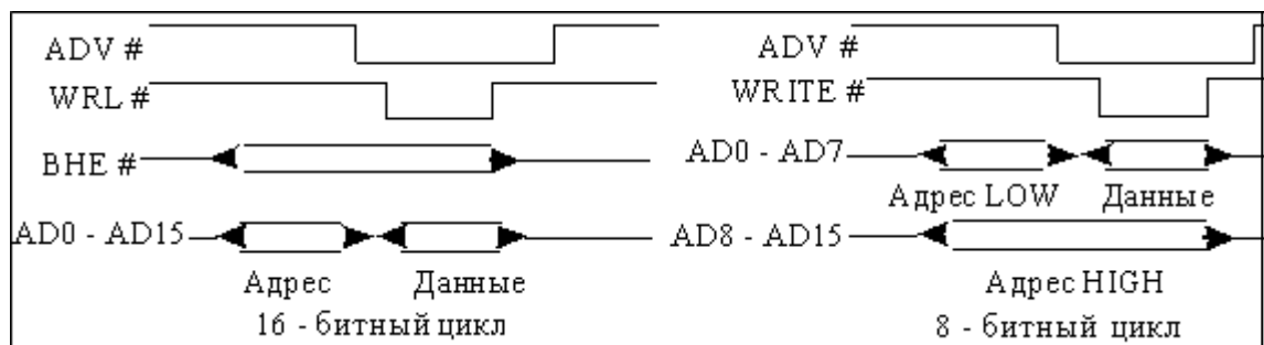
Рисунок 15.2.3 – Режим стробирования действительного адреса
