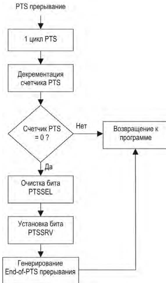
Рисунок 7.2 – Блок-схема цикла PTS
