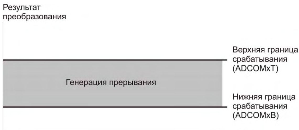
Рисунок 16.19 – Срабатывание компараторов по попаданию в диапазон
