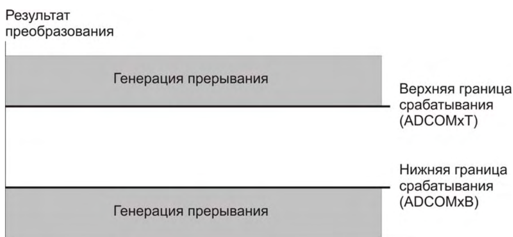
Рисунок 16.20 – Срабатывание компараторов по выходу из диапазона
