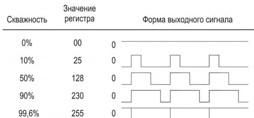
Рисунок 18.2 – Форма выходного сигнала PWM
