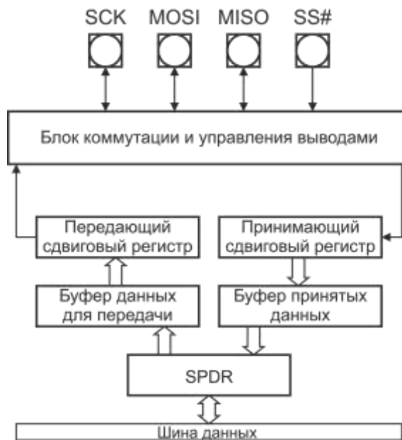
Рисунок 14.1 – Структурная схема взаимодействия блоков модуля SPI
