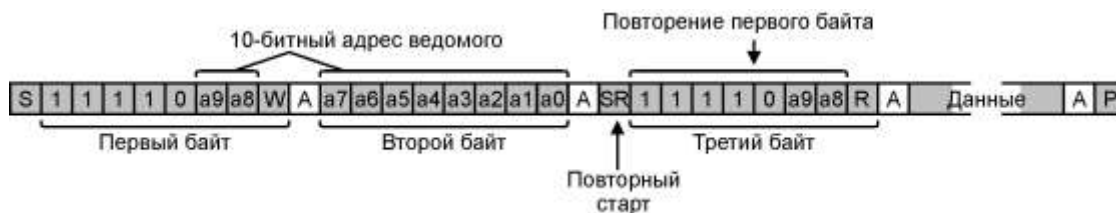
Рисунок 13.11 – Получение данных от ведомого с 10-битным адресом
