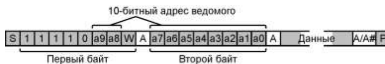
Рисунок 13.10 – Передача данных ведомому с 10-битным адресом (для расшифровки обозначений, применяемых на рисунке, следует обратиться к таблице 13.1)
