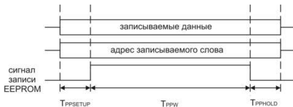
Рисунок 24.4 – Программирующий импульс EEPROM
