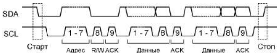
Рисунок 13.8 – Передача данных с 7-битной адресацией
