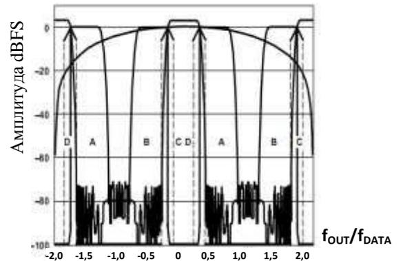
Рисунок 57 – Интерполяция 2×, комплексная модуляция  $f_{DAC}/8$
