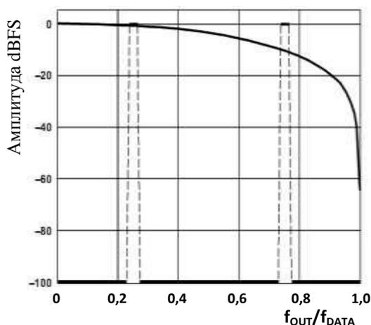
Рисунок 32– Модуляция =  $f_{DAC}/4$
