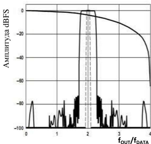
Рисунок 42 – 8× Интерполяция, модуляция блокирована,
