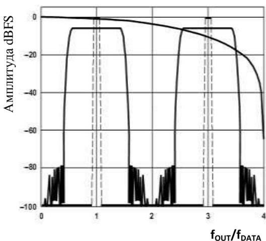
Рисунок 40 – 4× Интерполяция, модуляция =  $f_{DAC} / 4$
