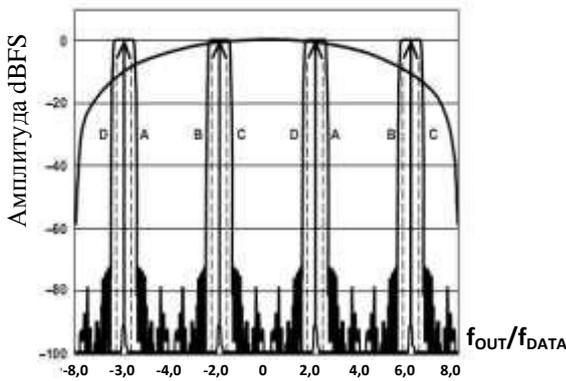
Рисунок 56 – Интерполяция 8×, комплексная модуляция  $f_{DAC}/4$
