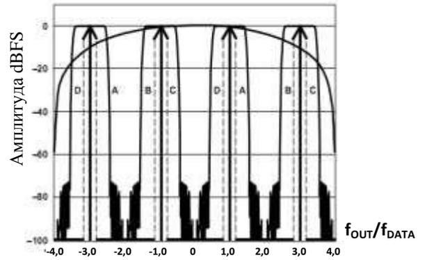
Рисунок 55 – Интерполяция 4×, комплексная модуляция  $f_{DAC}/4$
