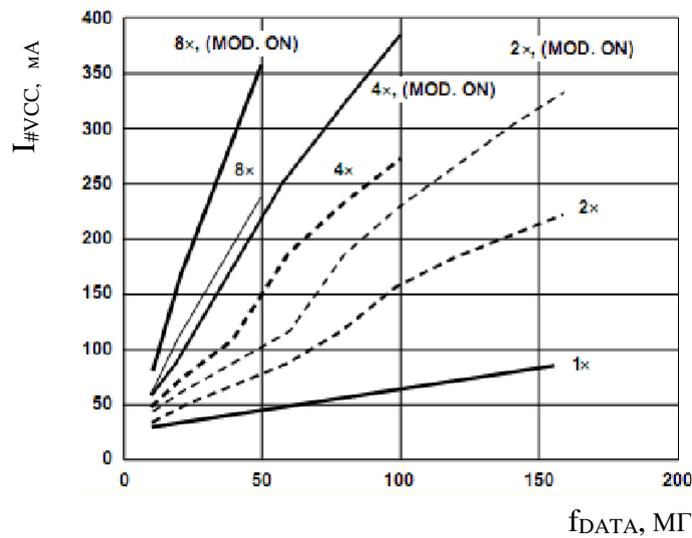
Рисунок 17 –  $I_{\#VCC}$  относительно  $f_{DATA}$ , коэффициента интерполяции (ФАПЧ запрещена)
