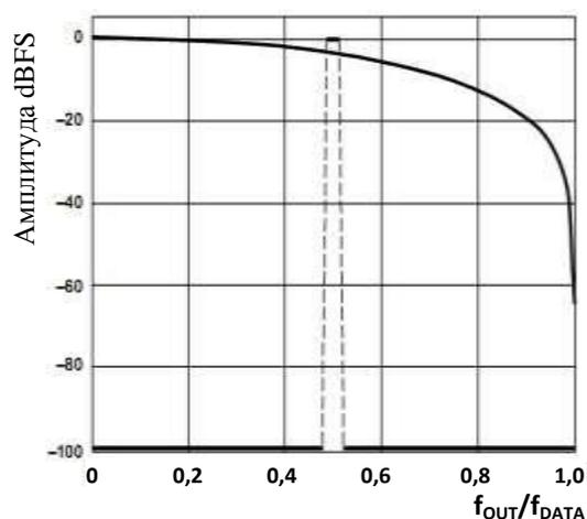
Рисунок 31 – Модуляция =  $f_{DAC}/2$
