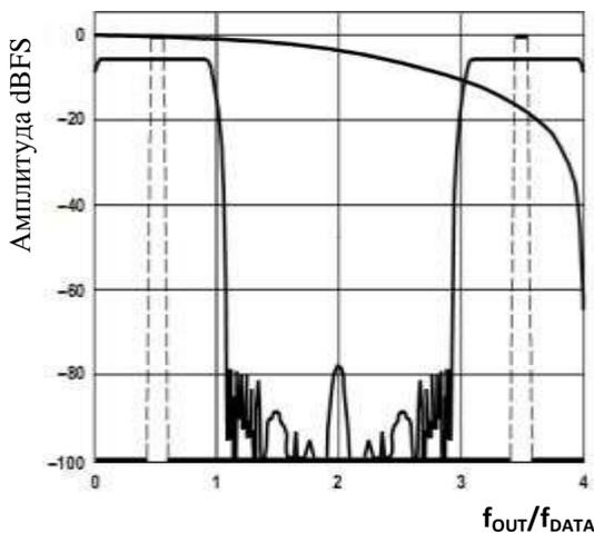
Рисунок 41 – 4× Интерполяция, модуляция =  $f_{DAC} / 8$
