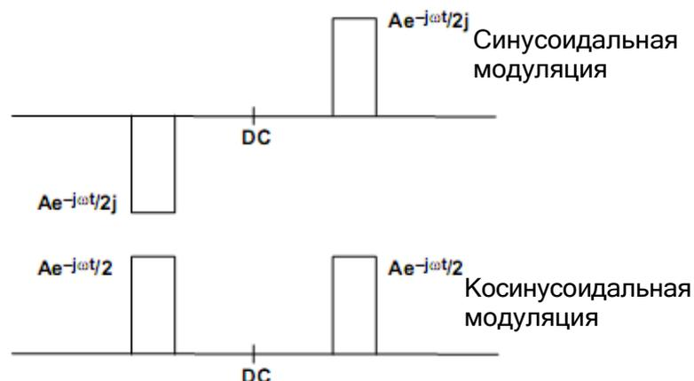
Рисунок 29 – Амплитудная модуляция синусом и косинусом
