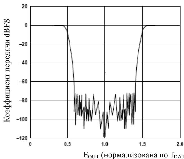
Рисунок 25 – АЧХ фильтра интерполятора 2×
