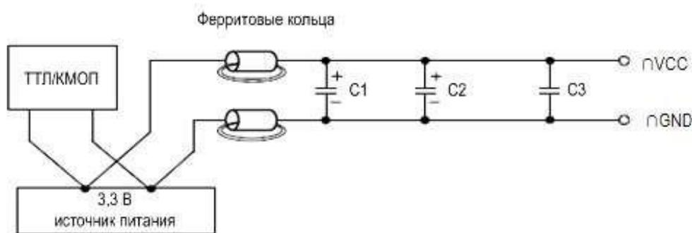
Конденсаторы: C1 = 100 мкФ – электролитический;
