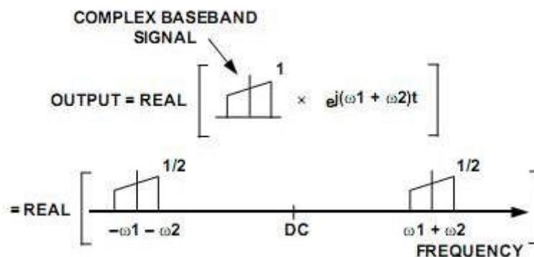
Рисунок 51 – Двухступенчатое комплексное преобразование с повышением частоты
