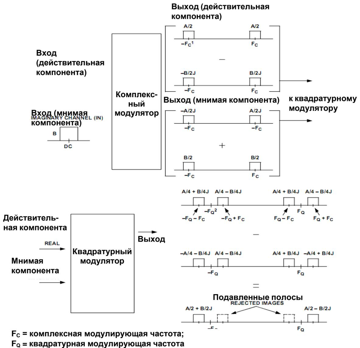
Рисунок 50 – Двухступенчатое преобразование с повышением частоты и подавлением одной боковой полосы
