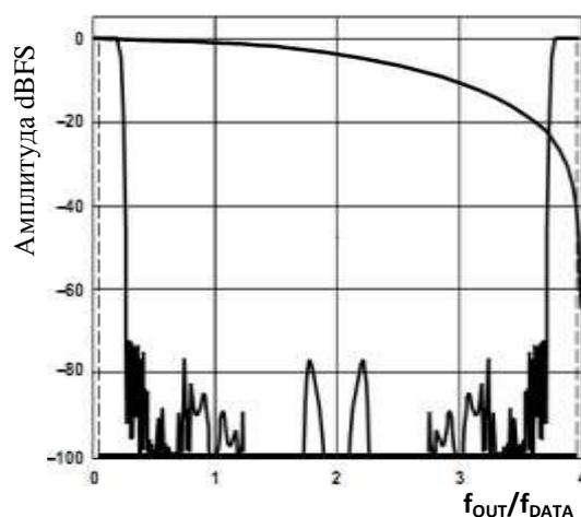
Рисунок 43 – 8× Интерполяция модуляция =  $f_{DAC}/2$
