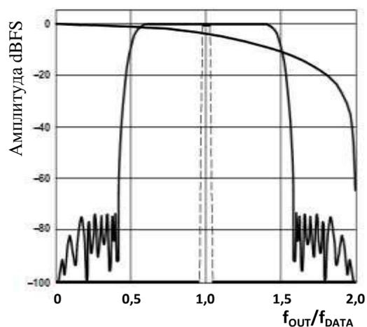
Рисунок 35 – 2 × Интерполяция, модуляция =  $f_{DAC} / 2$
