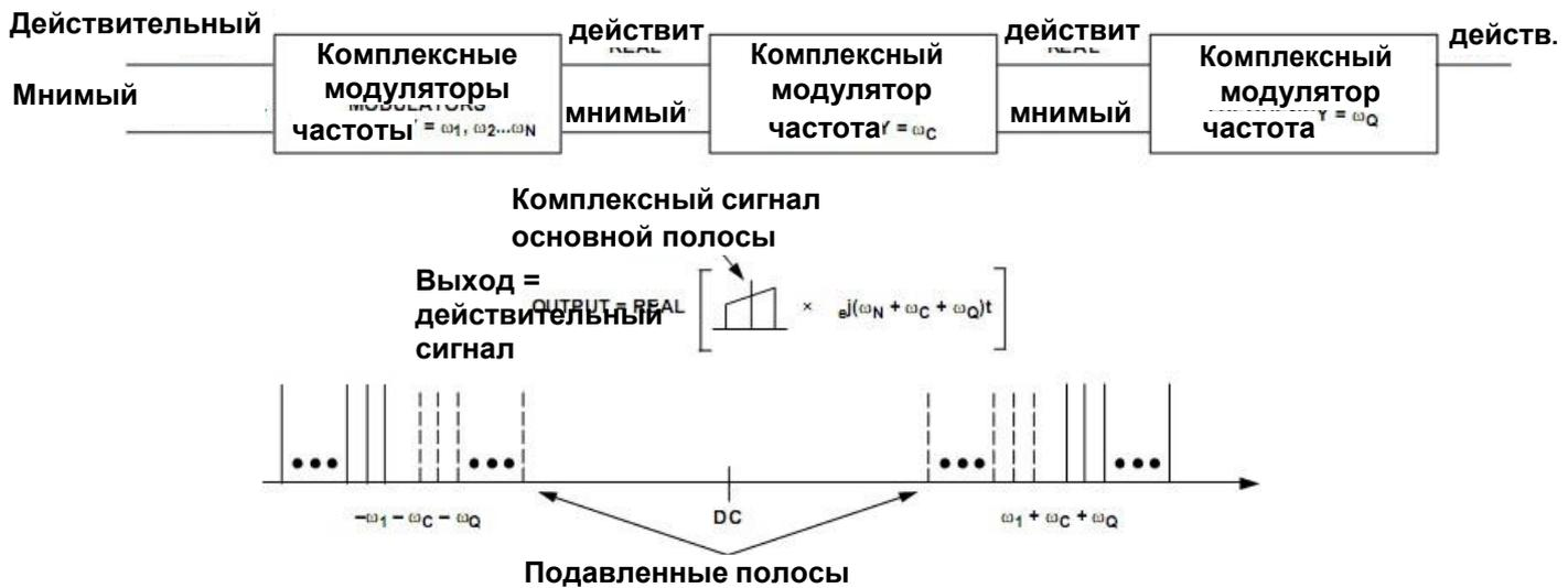
Рисунок 53 – Подавление боковой полосы с мультинесущим сигналом
