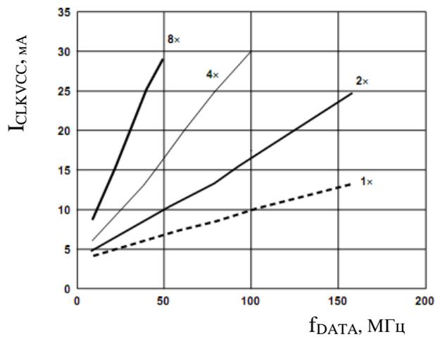
Рисунок 19 –  $I_{CLKVCC}$  относительно  $f_{DATA}$ , коэффициента интерполяции (ФАПЧ запрещена)
