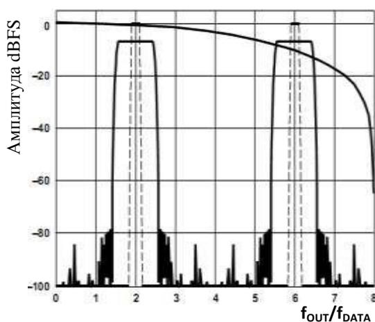
Рисунок 44 – 8× Интерполяция, модуляция =  $f_{DAC}/4$
