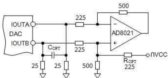
Рисунок 70 – Дифференциальное подключение, использующее операционный усилитель
