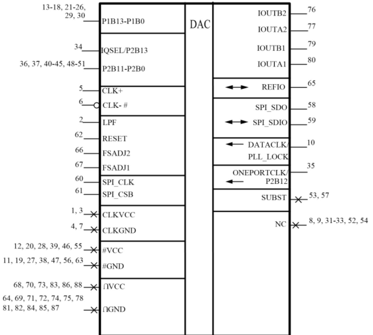
Рисунок 1 – Условное графическое обозначение ИС 1273ПА13Т
