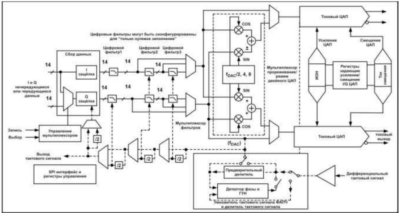
Рисунок 6 – Схема электрическая структурная микросхемы 1273ПА13Т
