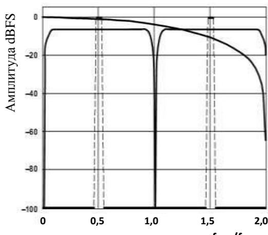
Рисунок 36 – 2 × Интерполяция, модуляция =  $f_{DAC} / 4$
