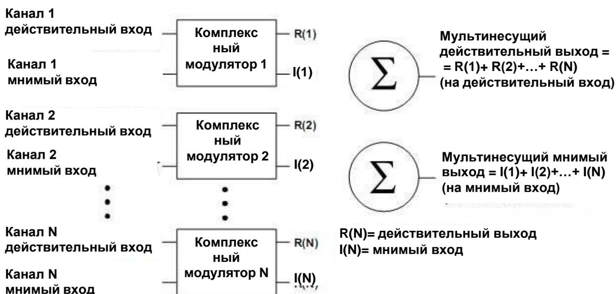
Рисунок 52 – Синтез комплексного сигнала на нескольких несущих
