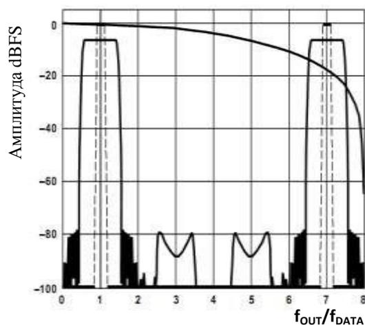
Рисунок 45 – 8× Интерполяция, модуляция =  $f_{DAC}/8$
