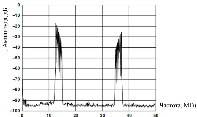
Рисунок 64 – Действительный вывод ЦАП 1273ПА13Т комплексного входного сигнала в основной полосе (только отрицательные частоты), интерполяция  $4\times$ , комплексная модуляция в 1273ПА13Т =  $-f_{DAC}/4$
