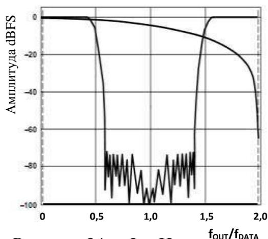
Рисунок 34 – 2 × Интерполяция, модуляция заблокирована
