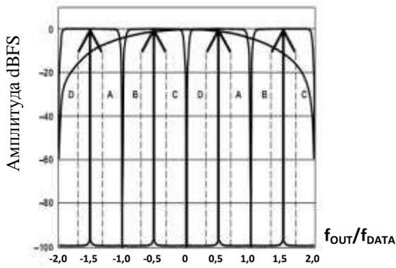
Рисунок 54 – Интерполяция 2×, комплексная модуляция  $f_{DAC}/4$
