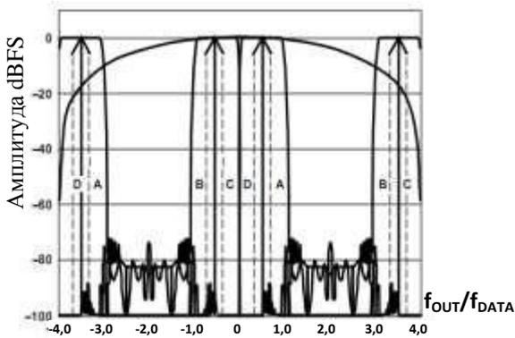
Рисунок 58 – Интерполяция 4×, комплексная модуляция  $f_{DAC}/8$
