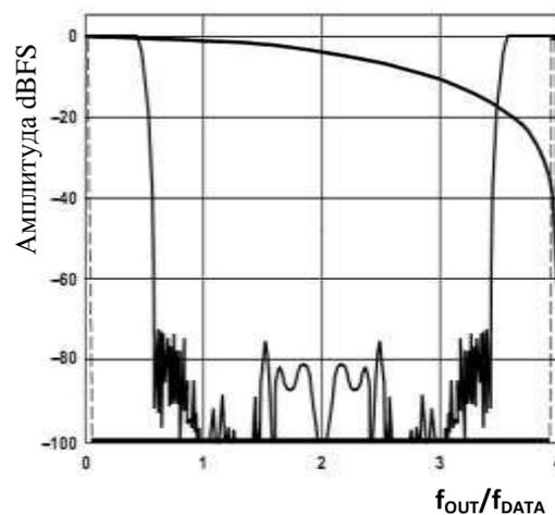
Рисунок 39 – 4× Интерполяция, модуляция =  $f_{DAC} / 2$
