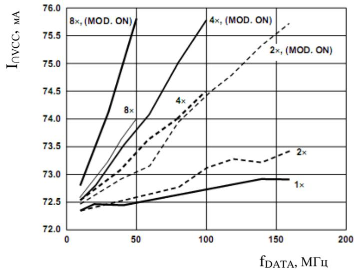
Рисунок 18 –  $I_{DVCC}$  относительно  $f_{DATA}$ , коэффициента интерполяции (ФАПЧ запрещена)
