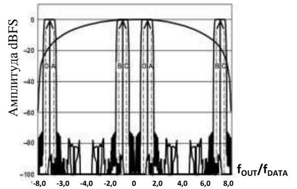
Рисунок 59 – Интерполяция 8×, комплексная модуляция  $f_{DAC}/8$
