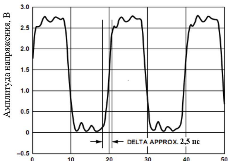
Рисунок 21 – Мощный формирователь на нагрузке 330 Ом, частота 50 МГц
