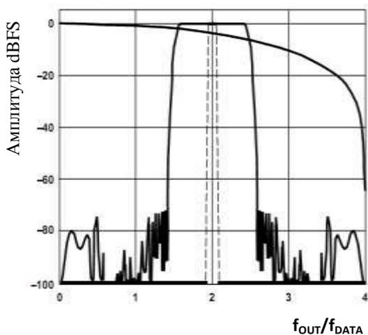
Рисунок 38 – 4× Интерполяция, модуляция блокирована
