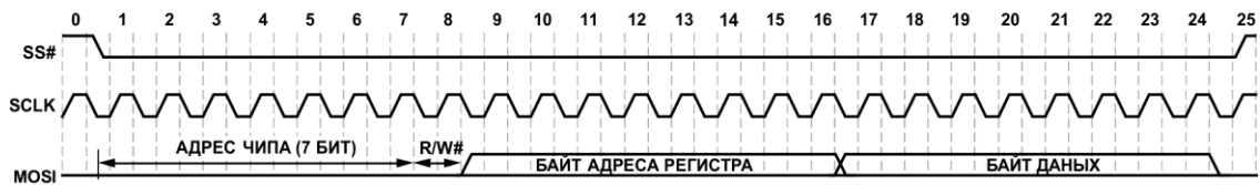
Рисунок 3.9 - Временная диаграмма сигналов при операции записи по SPI
